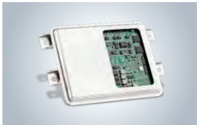
Vue intérieure d'un boîtier électronique déporté
