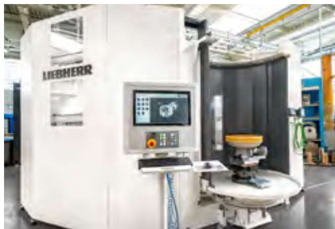
Un co-développement Liebherr : le nouveau centre d'usinage à cinq axes équipé d'un système de chargement rotatif chez Liebherr-Aerospace à Campsas
