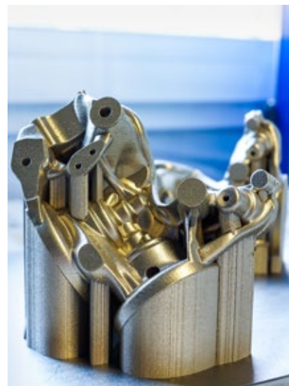
Corps de vanne semi-fini produit à Toulouse, avant élimination des supports de production.
