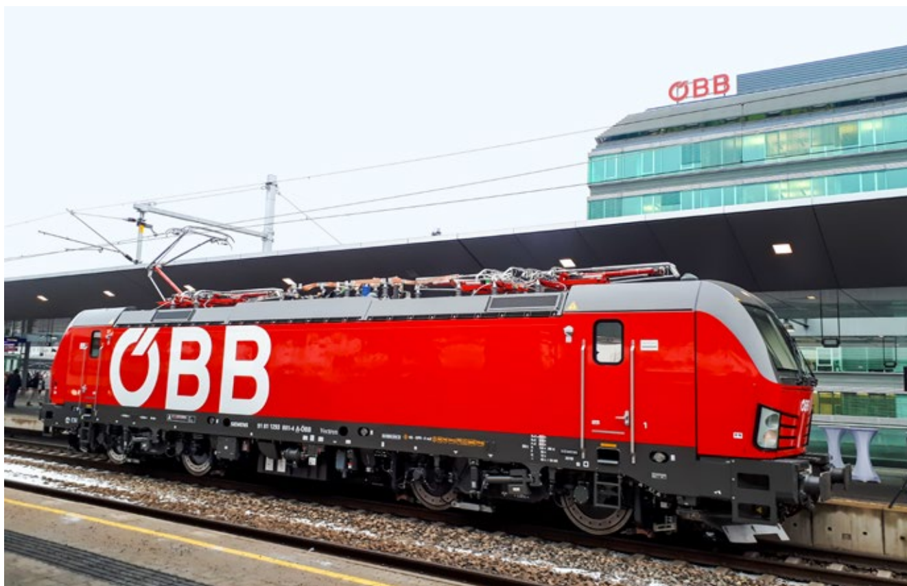
Les nouvelles locomotives Vectron des ÖBB pèsent 90 tonnes. Elles ont à leur bord des amortisseurs latéraux actifs fabriqués par Liebherr.
