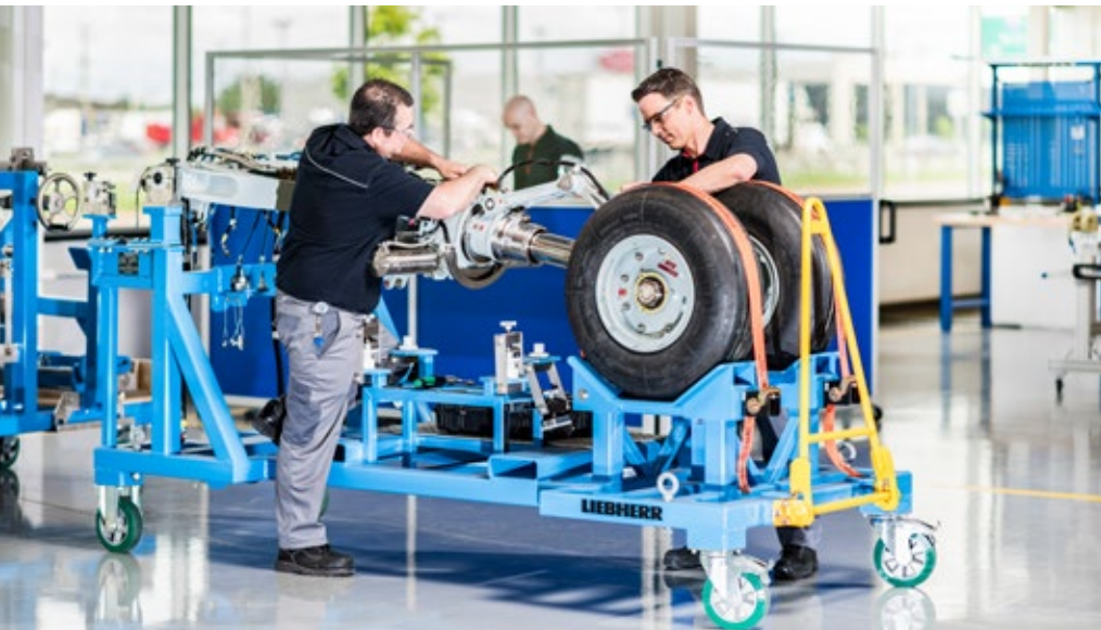
Montage d'un châssis à Laval (Kanada)
