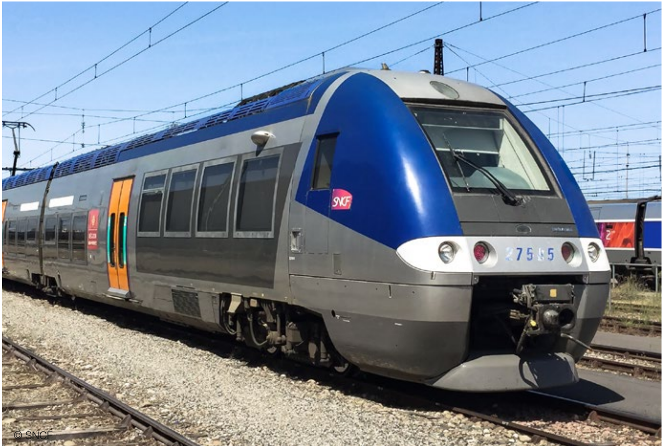
Le système de climatisation « Eco-Clim » utilise l'air à la place des réfrigérants chimiques.
