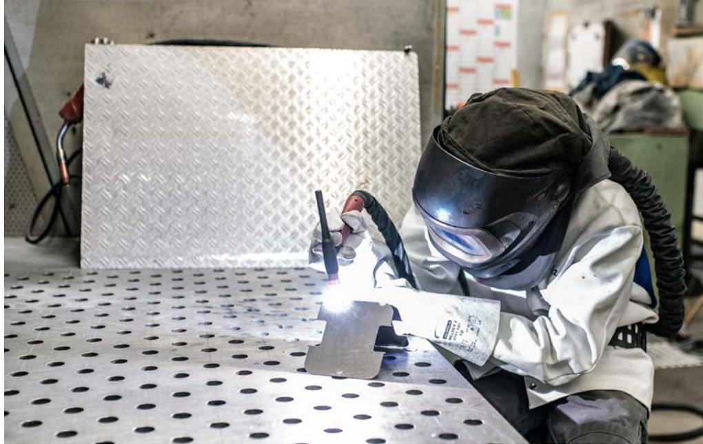
Mittels Wolfram-Inertgas-Schweißverfahren fertigt ein Auszubildender eine Aluminium-Blechkonsole
