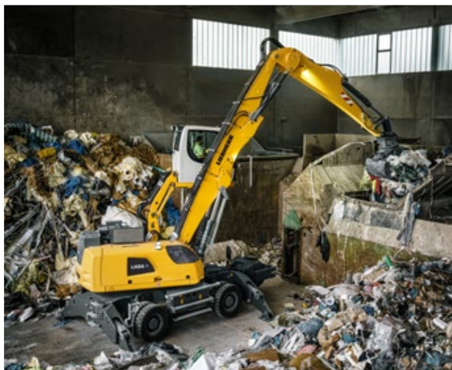
Elektryczny LH 26 M Industry Litronic przy pracach recyklingowych
