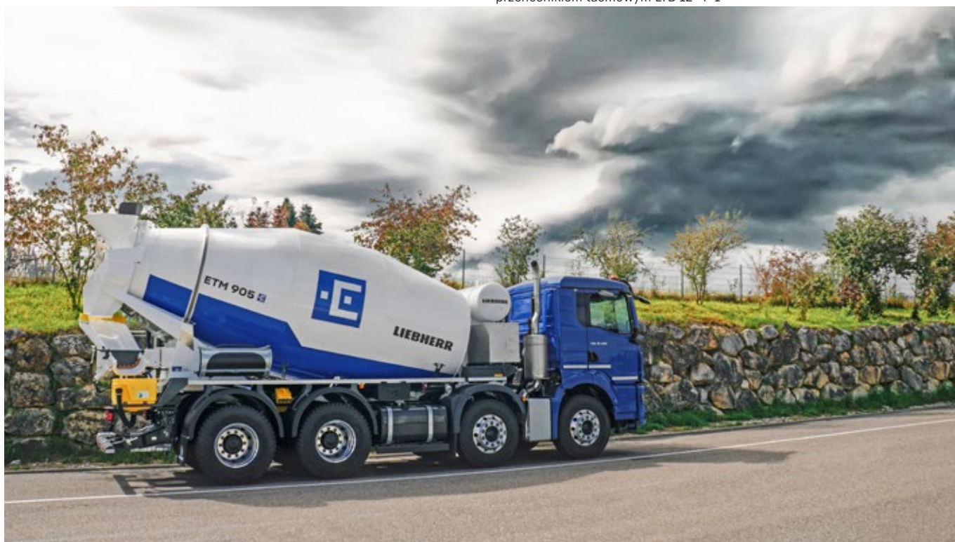
Elektryczna betoniarka samochodowa nowej generacji 05
