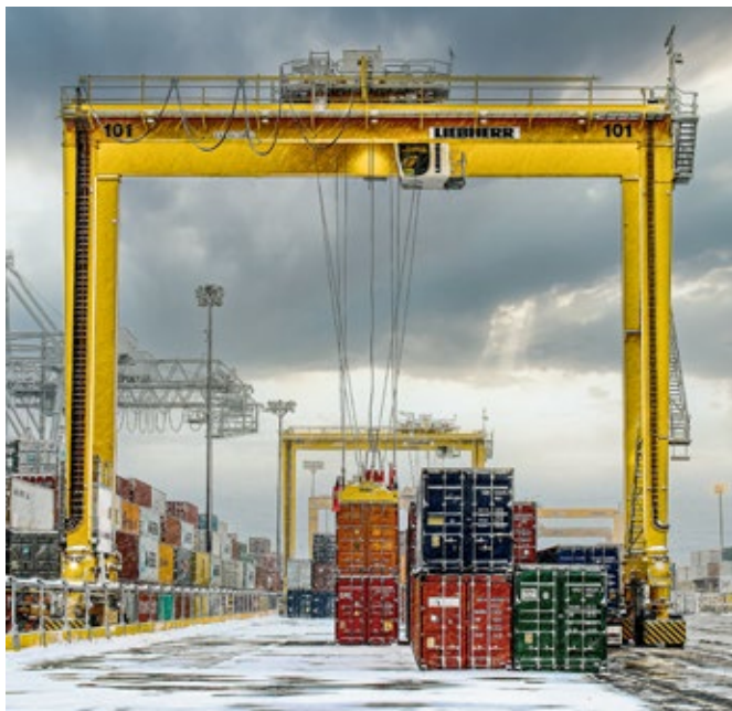
Żuraw Liebherr z napędem elektrycznym na suwnicy z gumowymi oponami w terminalu w Montrealu (Kanada)
