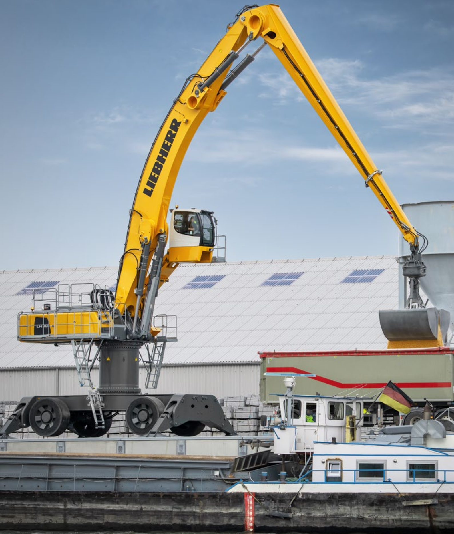
LH 110 M High Rise Port Litronic przy portowych pracach przeładunkowych
