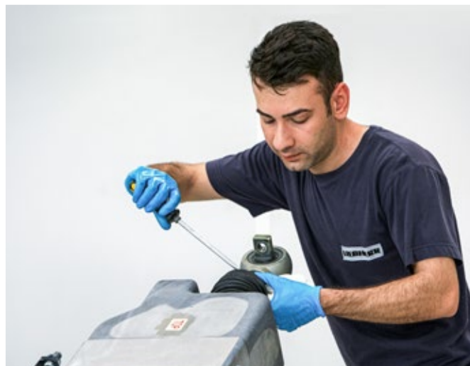
Konserwacja siłownika elektryczno-hydraulicznego
