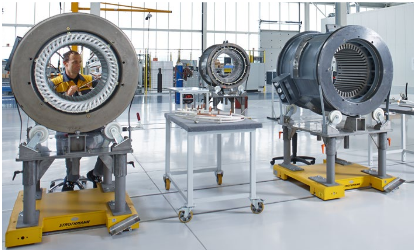
Nawijalnia uzwojeń maszyn elektrycznych dla wozideł górniczych i żurawi portowych
