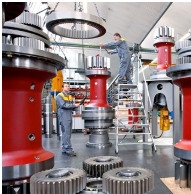
Montaż napędów wieńcowych DAT 1000
