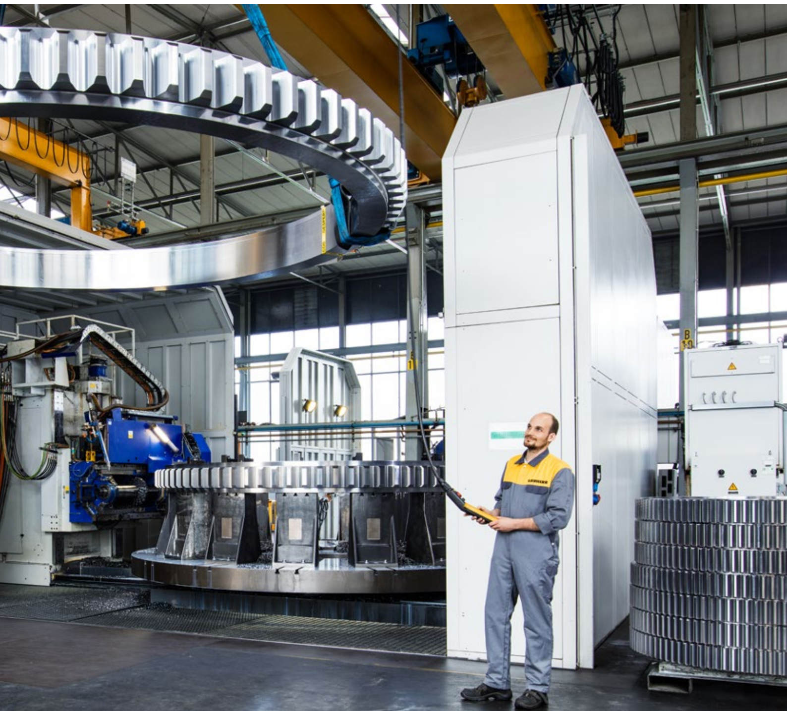
Obróbka precyzyjna poprzez szlifowanie i polerowanie
