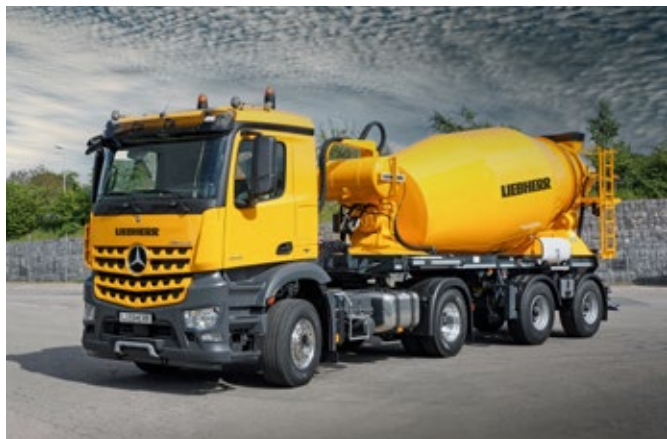
Dopuszczalna masa całkowita betoniarki samochodowej HTM 1004 ZA/38 to 38 t
