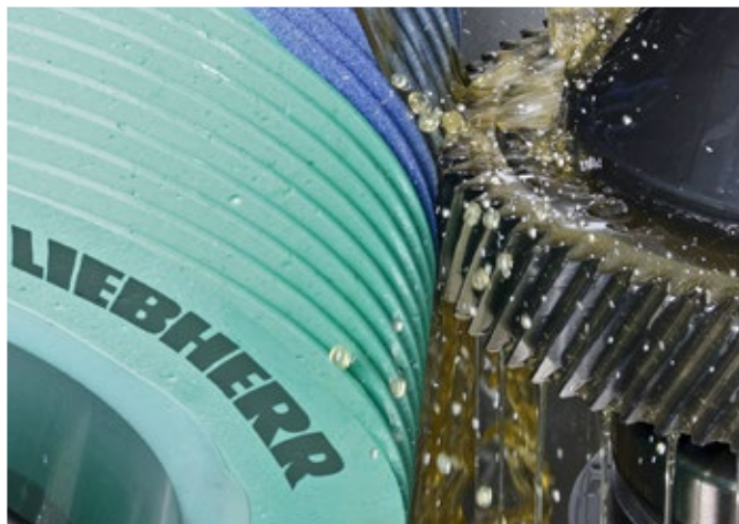
Obróbka precyzyjna poprzez szlifowanie i polerowanie
