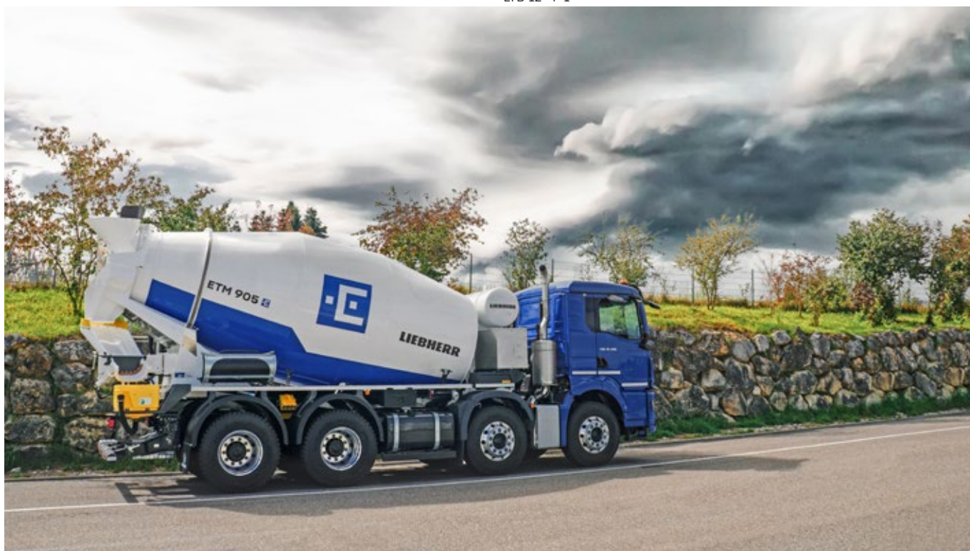
Autobetonieră electrică pentru camioane din noua generație 05
