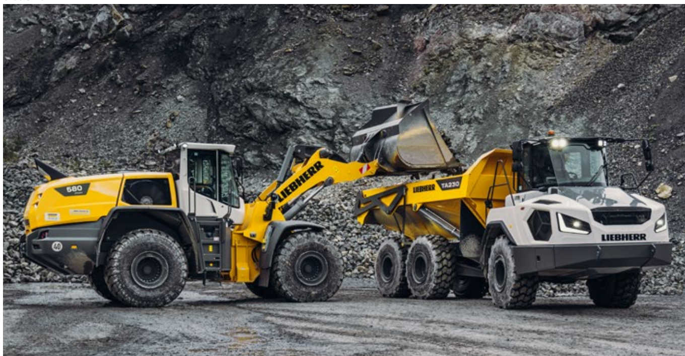
L 580 XPower® încărcând o autobasculantă articulată
