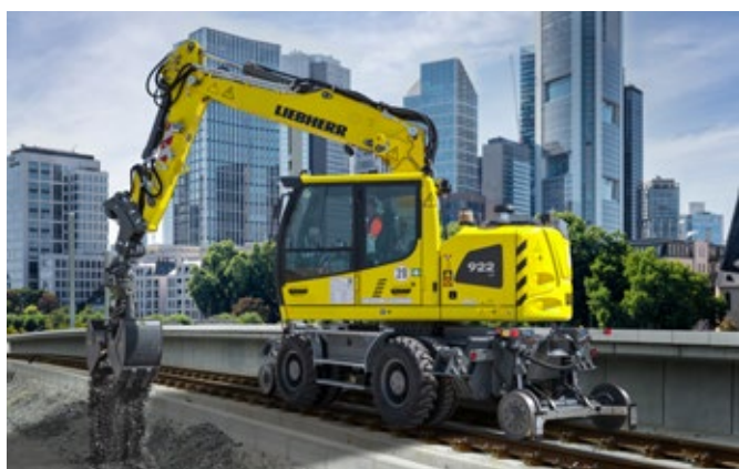
A 922 în funcțiune pentru lucrări de pietruire pe o linie de cale ferată din Frankfurt am Main (Germania)
