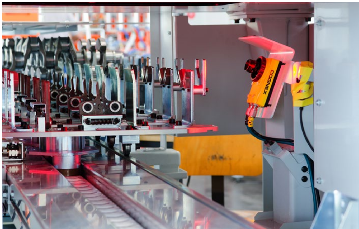
Transportor cu lanț din material plastic (KKB) utilizat ca sistem de transport al arborilor cotiți
