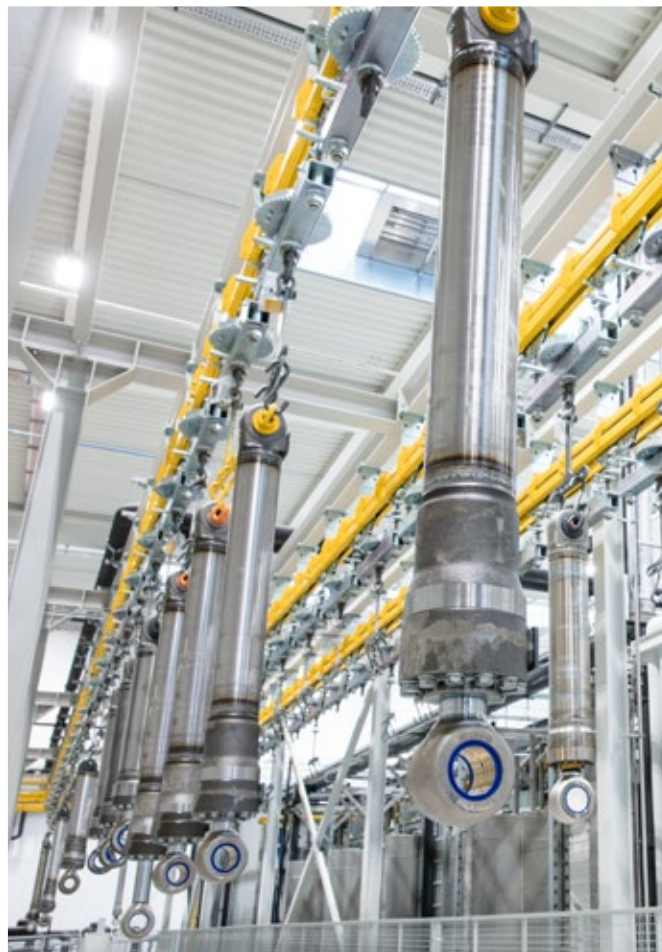
Instalație de vopsire robotizată pentru cilindri hidraulici standard
