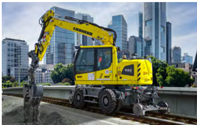
A 922 Rail 用于德国法兰克福一条铁路线的铺装作业
