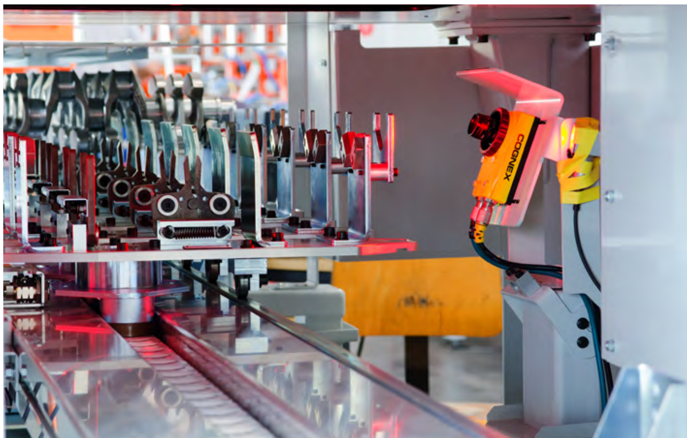
用作例如曲轴输送系统的塑料链带 (KKB)
