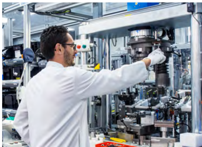
净室中共轨系统的安装
