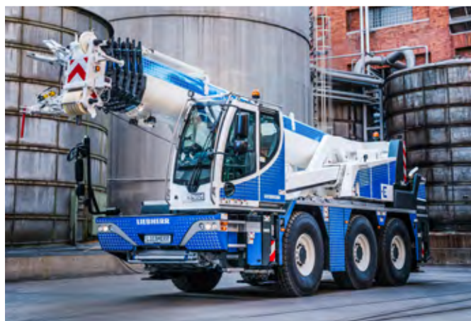
利勃海尔紧凑型起重机的特点是尺寸小巧。混合动力型设备可选择通过电动马达控制起重机运动。
