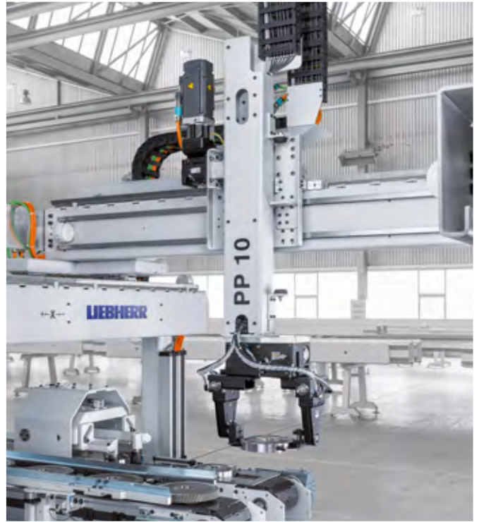
桁架式机器, 用于重量介于 0.5 kg 至 1500 kg 的工件
