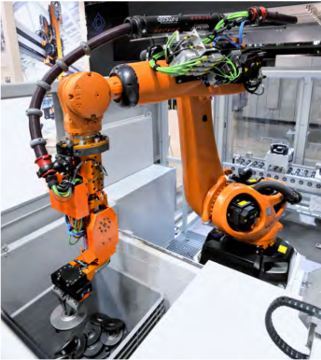
Bin Picking 机械手捡拾系统: 以经济的方式实现散货的卸货
