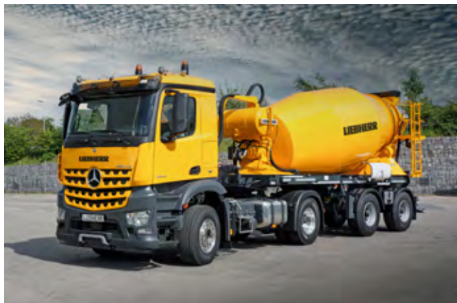
混凝土搅拌车 HTM 1004 ZA/38 允许的总重量达 38 吨。
