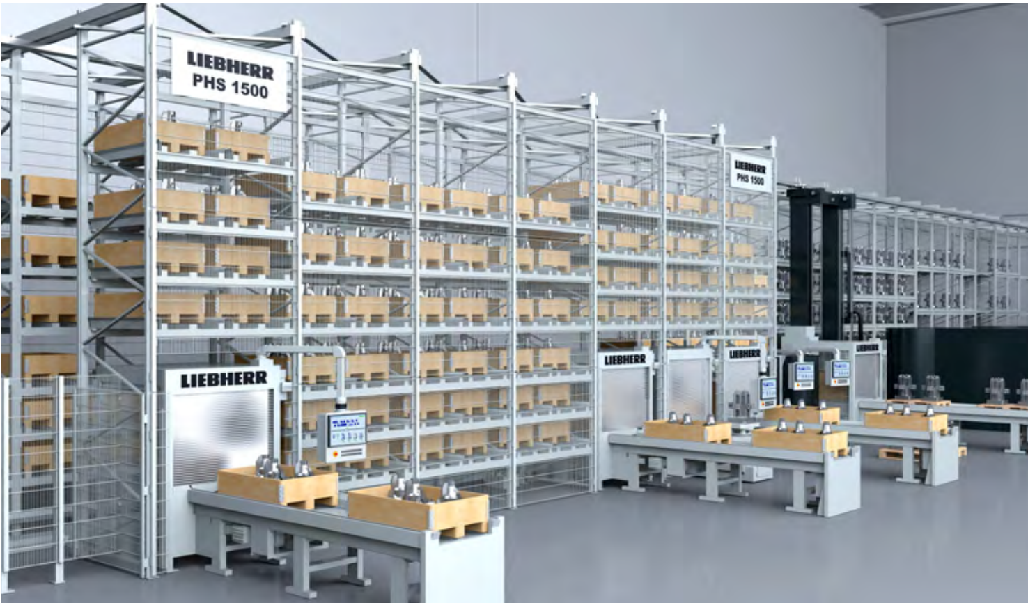
直线托盘搬运系统 (PHS), 用于 500 kg 至 13,000 kg 的运输负载
