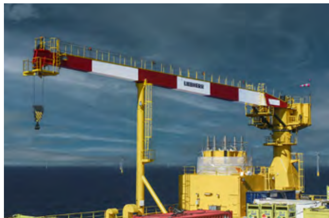
RL 系列的 RL 1500 设计经过特别优化，结构紧凑，可用于固定式和浮动式海上设施的维护和供应工作。
