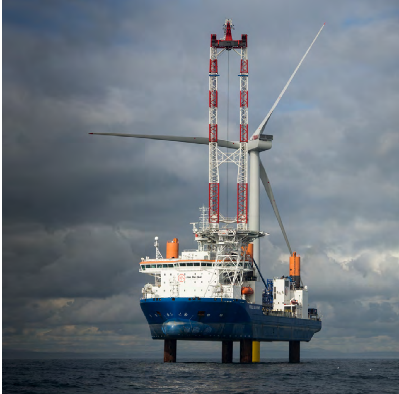
这台在“Vole au Vent”上运行的 CAL 45000 海上起重机被设计为支腿环绕式起重机,能够举升最多 1,200 吨货物。
