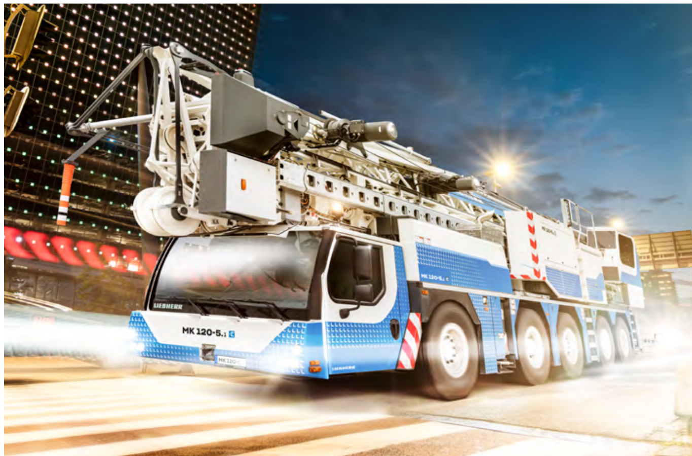
MK 移动式施工起重机 (如图中所示的全新 MK 120-5.1) 可以在一天内执行多种应用。这些起重机利用现场电源, 对当地产生零排放。
