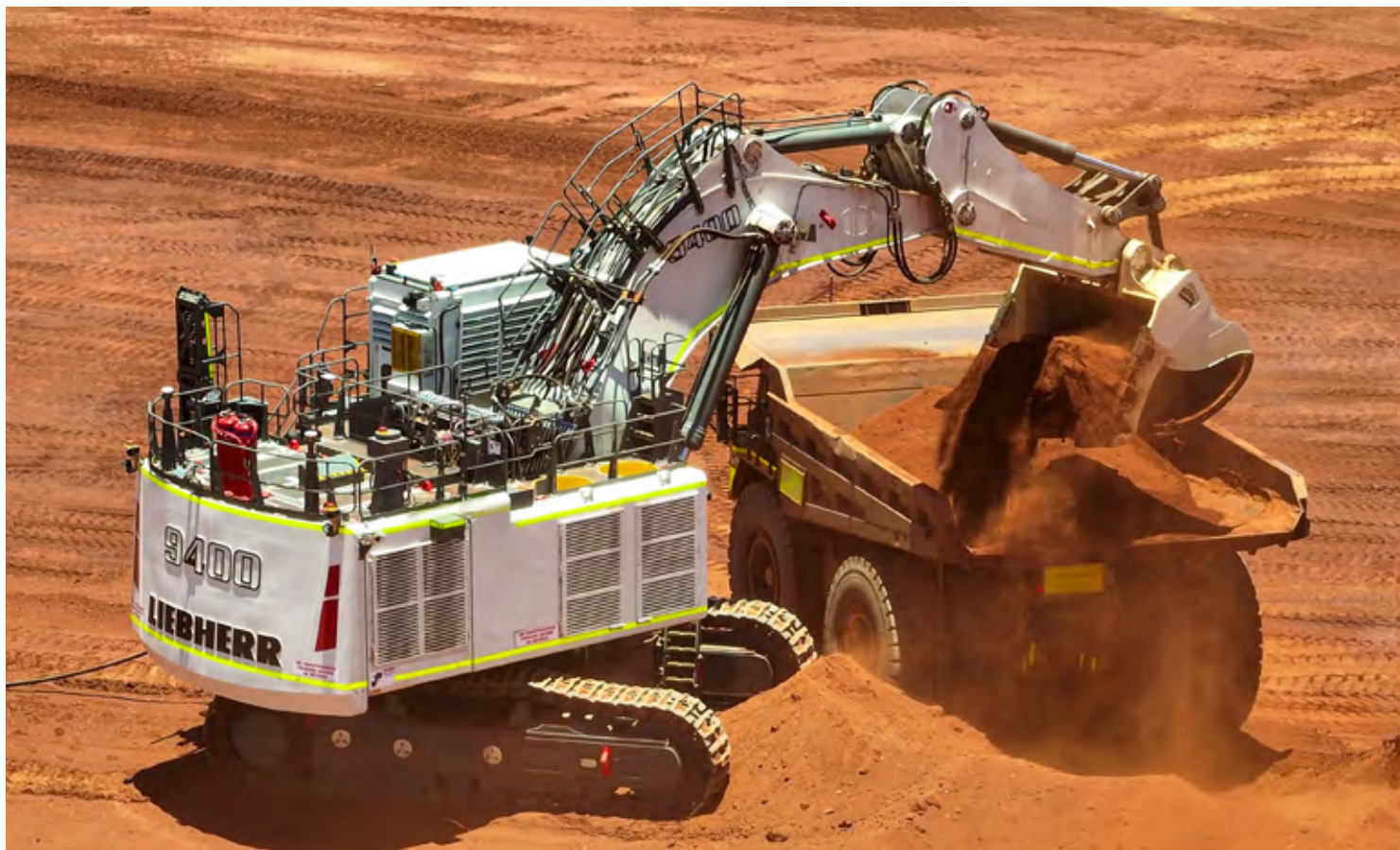
R 9400 E 电动挖掘机在澳大利亚的一个矿井中作业
