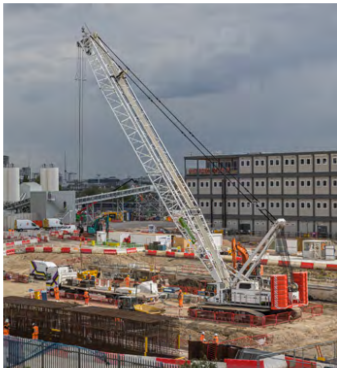
LR 1250.1 非插电电池驱动型履带式起重机在伦敦 (英国) 用于升降作业
