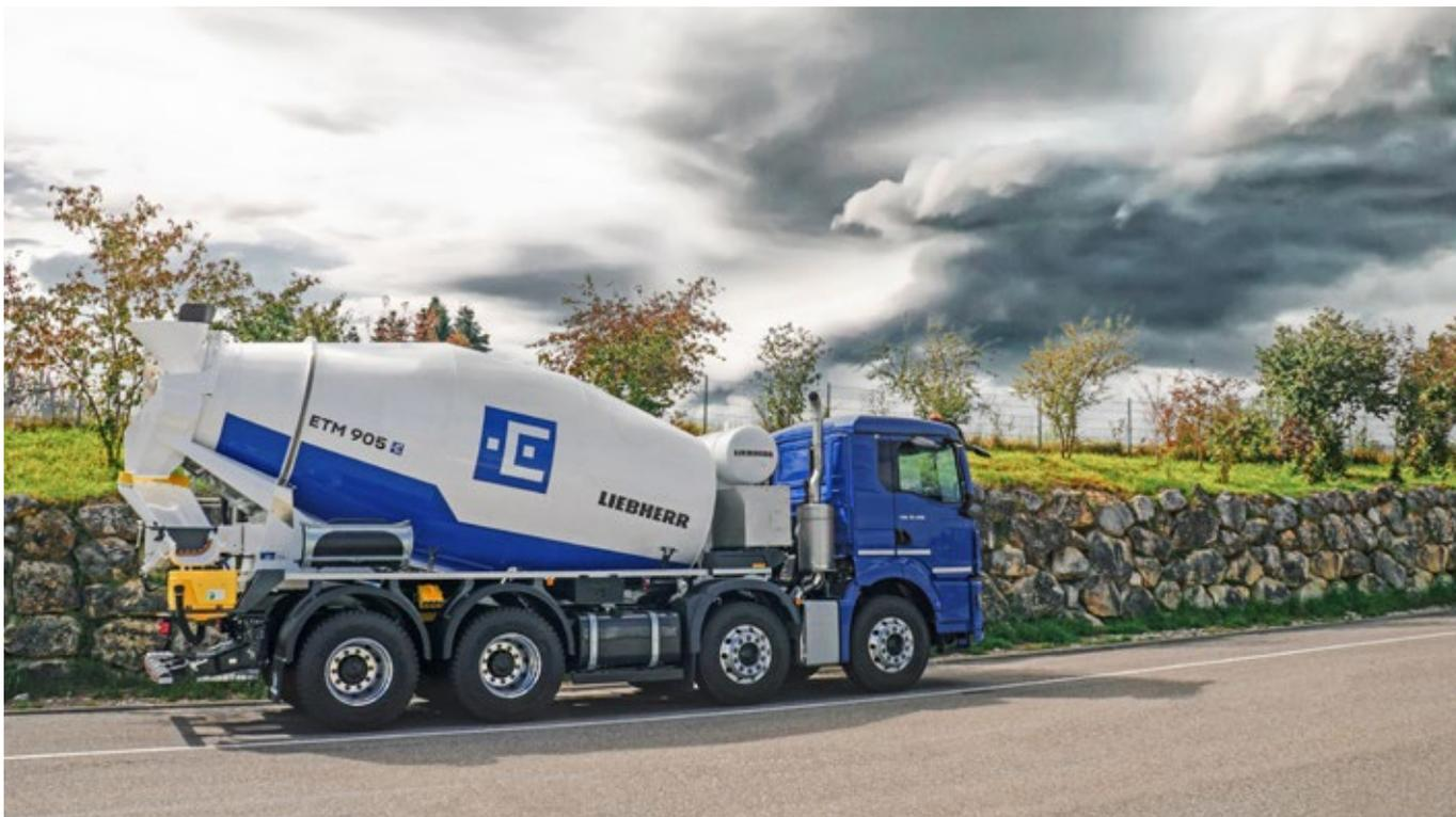
Bétonnière portée électrique de la nouvelle génération 05
