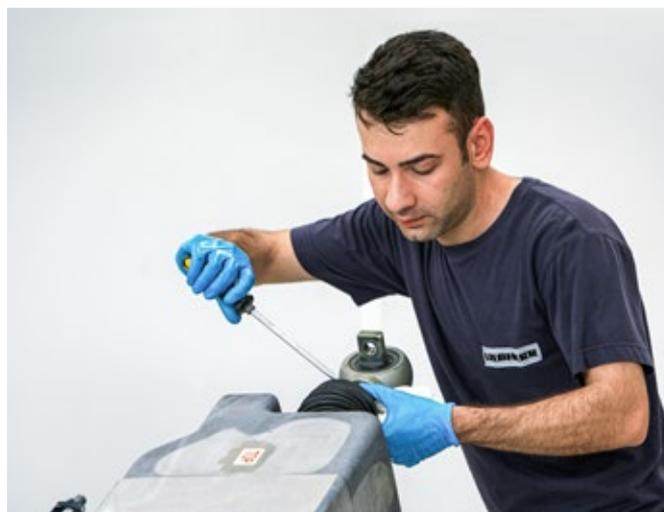
Maintenance d'un actuateur électrohydraulique
