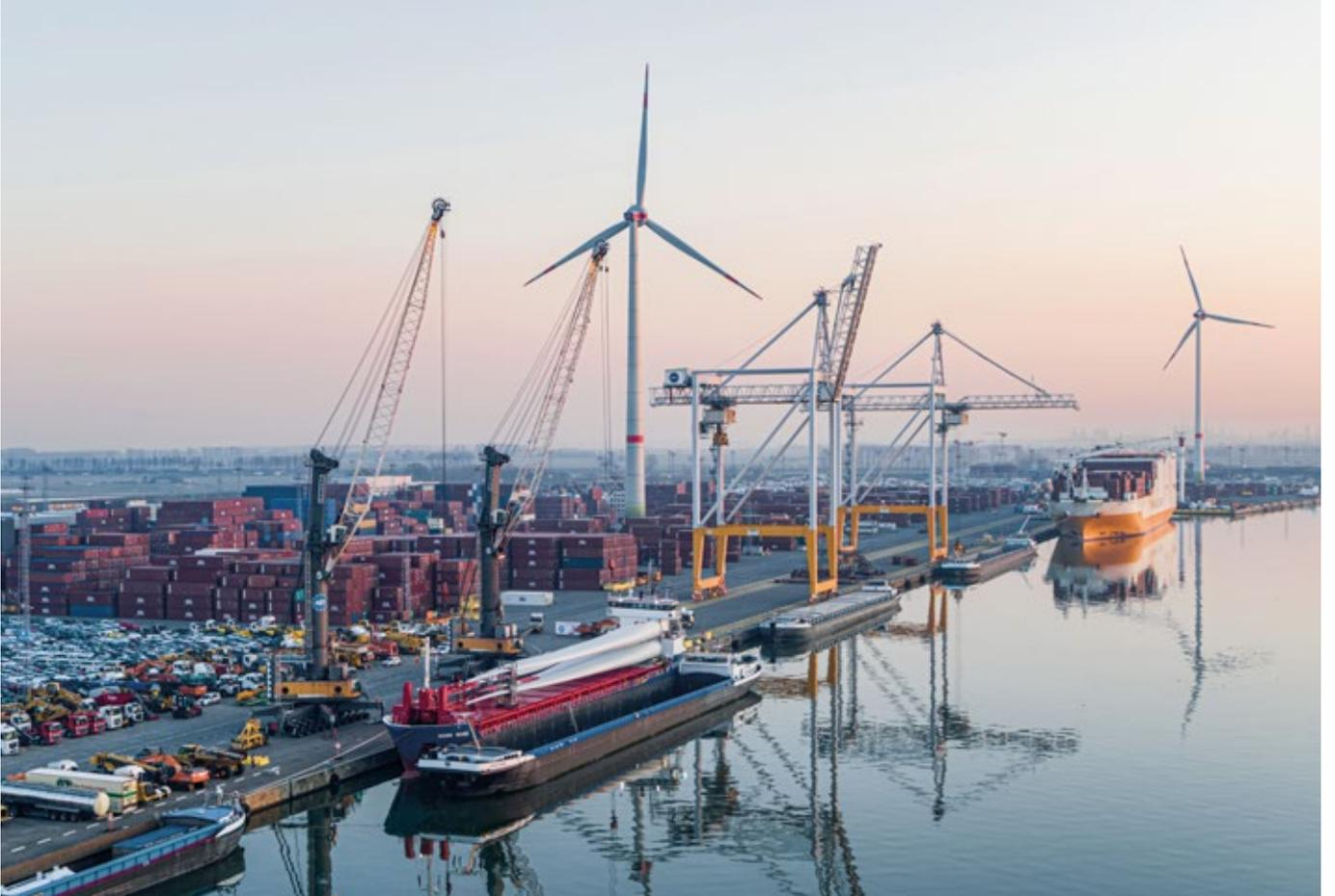
Deux grues mobiles portuaires de type LHM 550 lors d'une opération de levage en tandem à l'Euroterminal d'Anvers (Belgique)
