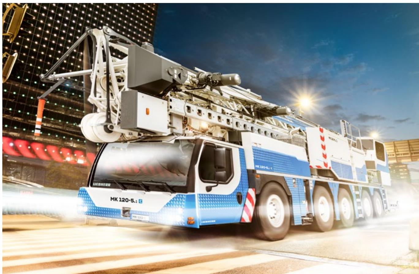
Les grues mobiles de construction MK, comme la nouvelle MK 120-5.1 visible sur la photo, accomplissent plusieurs missions par jour. L'utilisation de l'alimentation électrique du chantier leur permet de fonctionner sans émissions locales.
