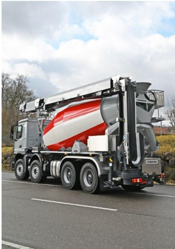
La bétonnière portée HTM 1005 à tapis convoyeur avec bande télescopique double LTB 12+4+1
