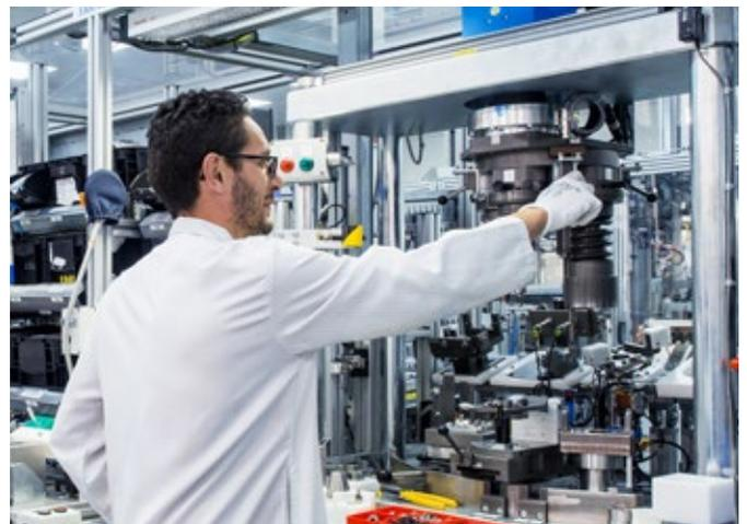
Montage des systèmes d'injection Common-Rail en salle blanche
