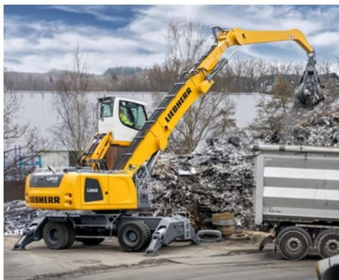
La LH 40 M Industry Litronic utilisée pour la manutention de ferraille
