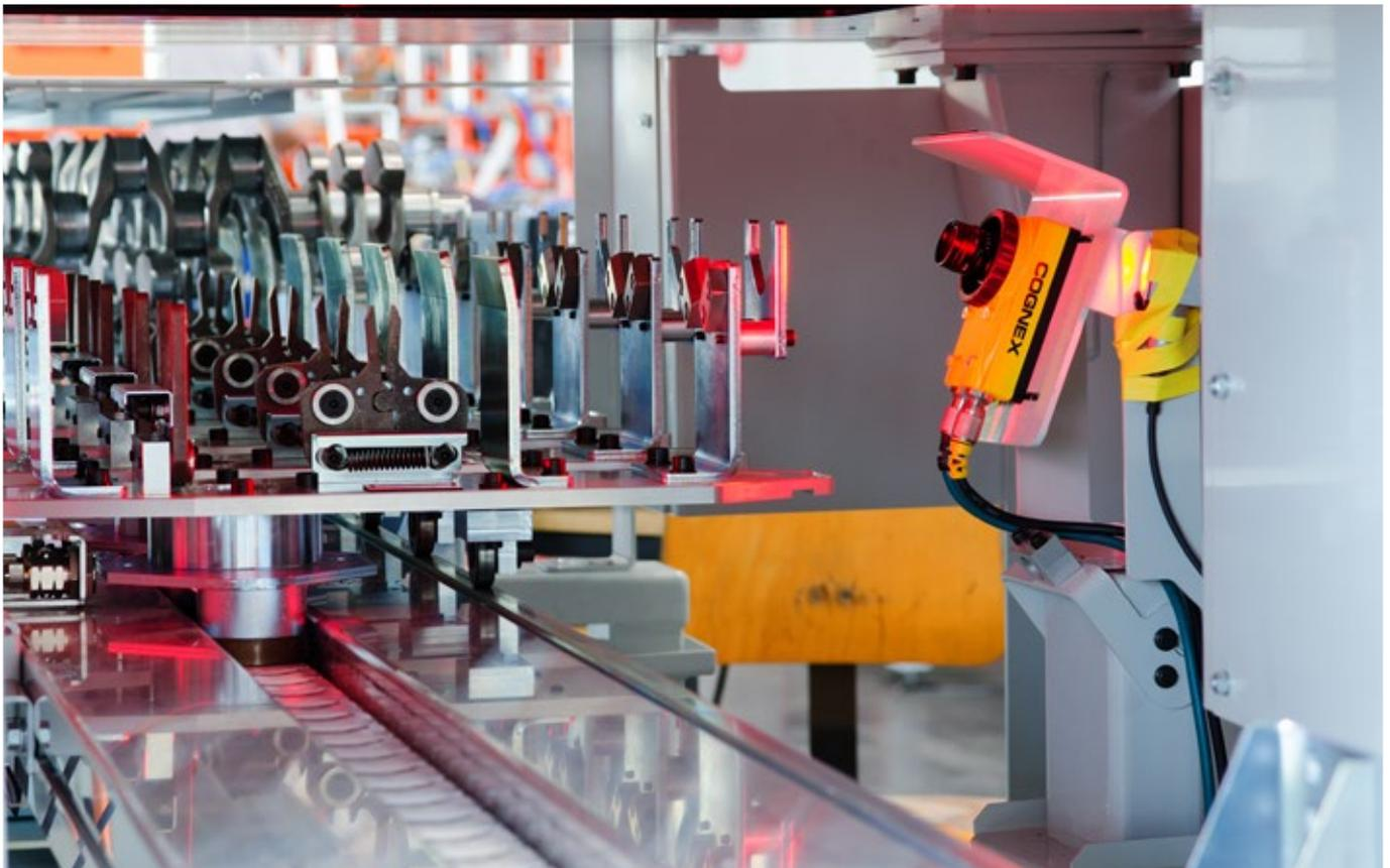
Le convoyeur à chaîne en plastique (KKB), utilisé par exemple pour le convoyage de vilebrequins
