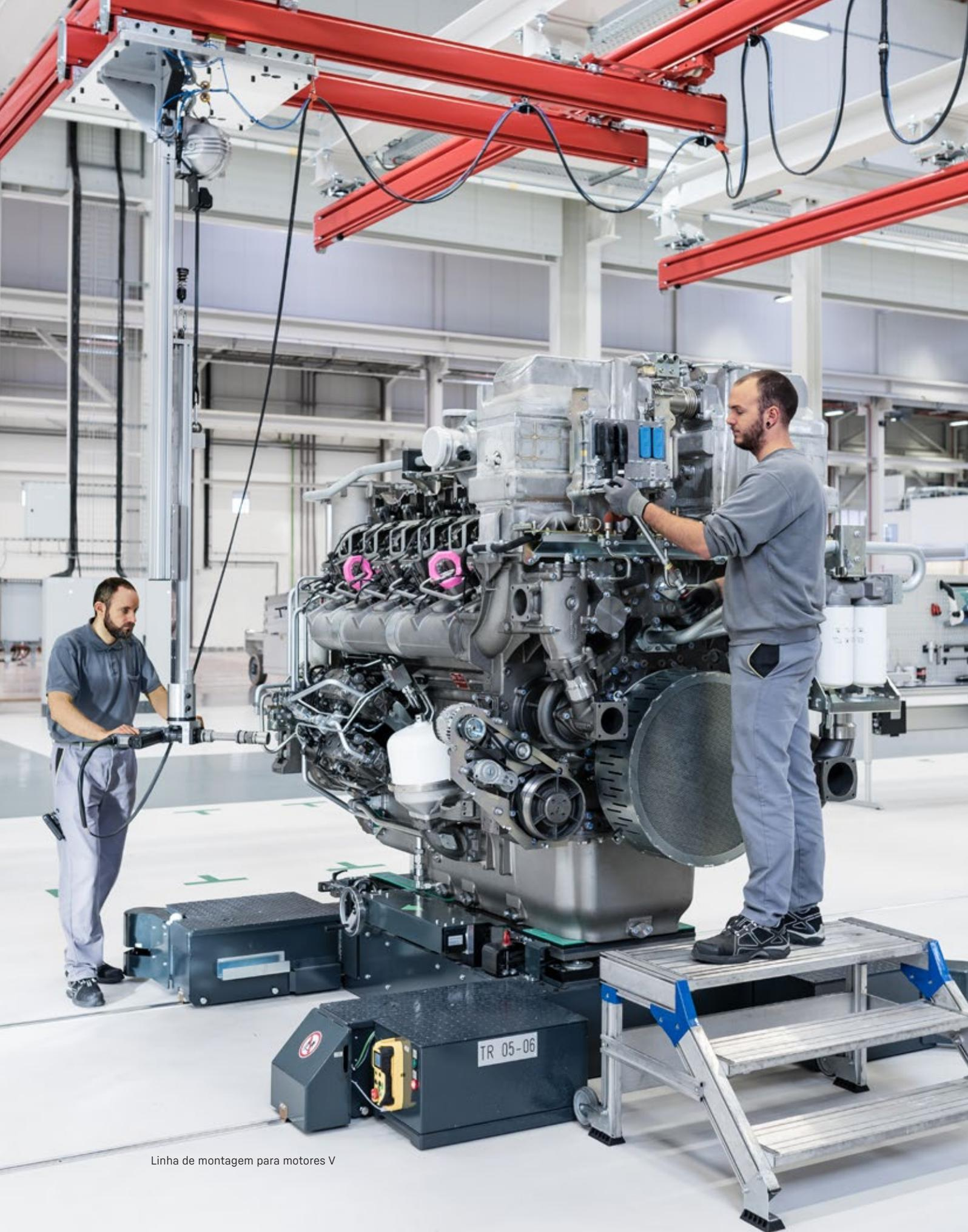
Linha de montagem para motores V
