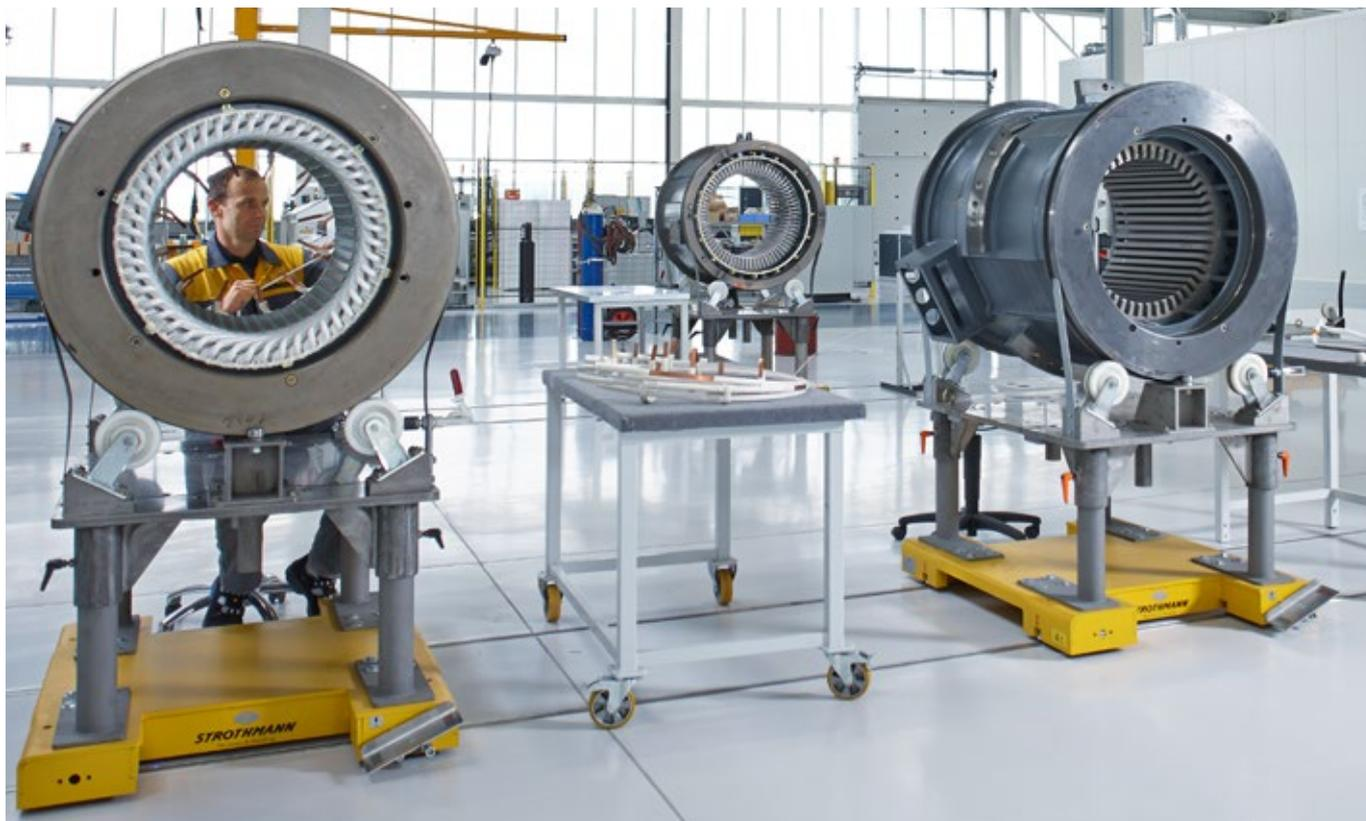
Bobinagem de motores elétricos para caminhões de mineração e guindastes portuários
