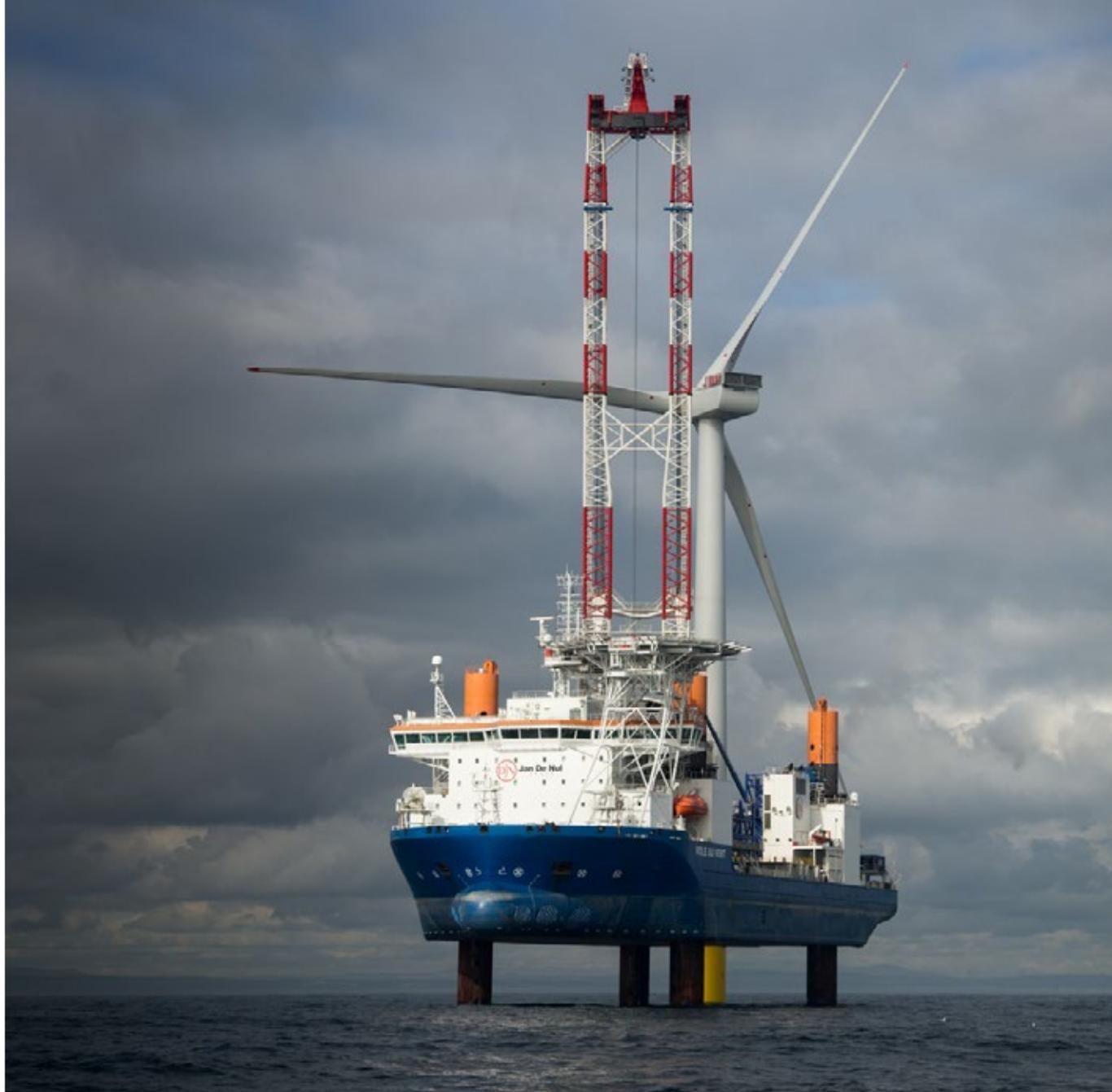
Este guindaste offshore “around the leg” CAL 45000, em operação a bordo do Vole au Vent, é capaz de levantar até 1.200 toneladas.
