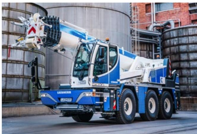
Os guindastes compactos da Liebherr se destacam pelas medidas compactas. O modelo híbrido opcionalmente pode comandar os movimentos do guindaste por meio de um motor elétrico.
