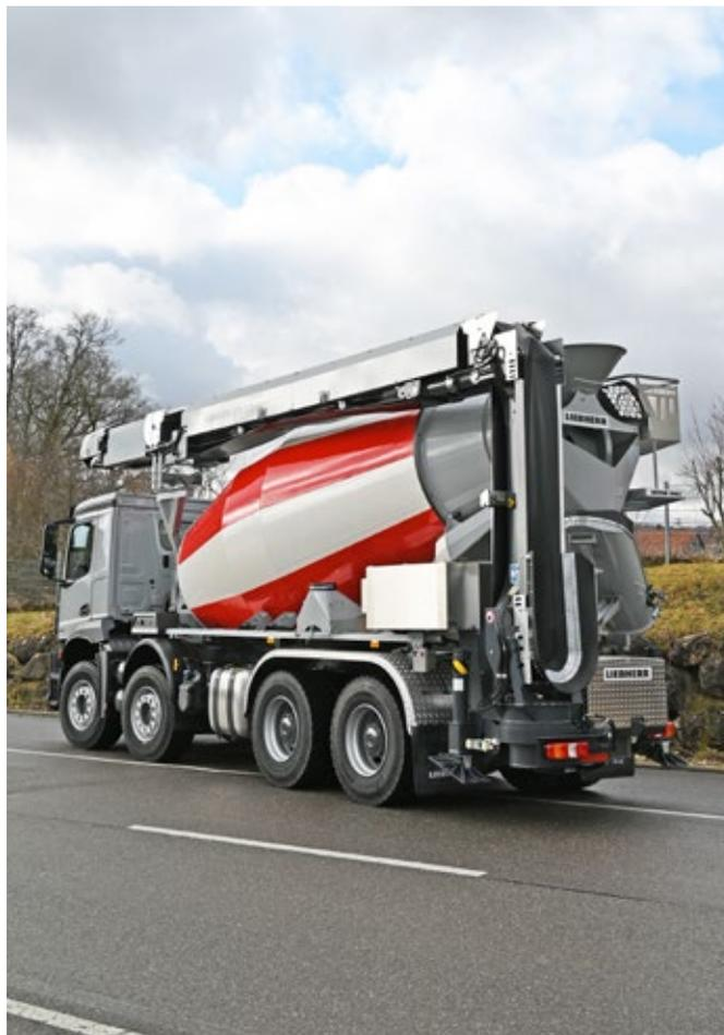
O caminhão betoneira HTM 1005 com esteira de transporte de duplo telescópio LTB 12+4+1
