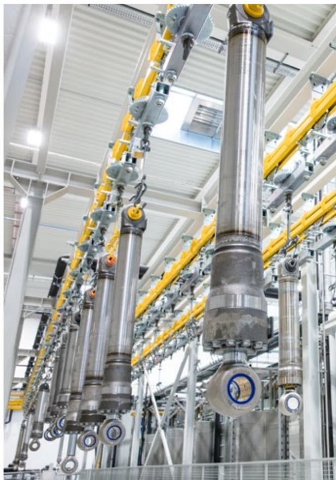
Linha de revestimento robotizada para produção em série de cilindros hidráulicos
