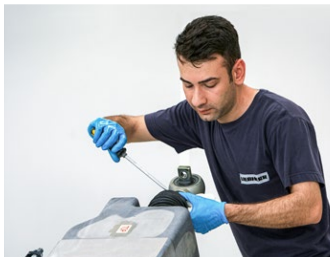
Údržba elektrohydraulického ovládače
