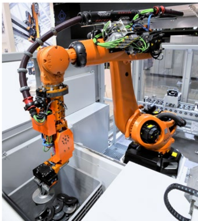
Bin Picking: hospodárné vykládání volně loženého materiálu
