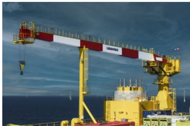
RL 1500 z řady RL se vyznačuje svou zvláště optimalizovanou a kompaktní konstrukcí. Lze ho používat pro účely údržby a dodávky materiálu na stacionárních a plovoucích instalacích na moři.
