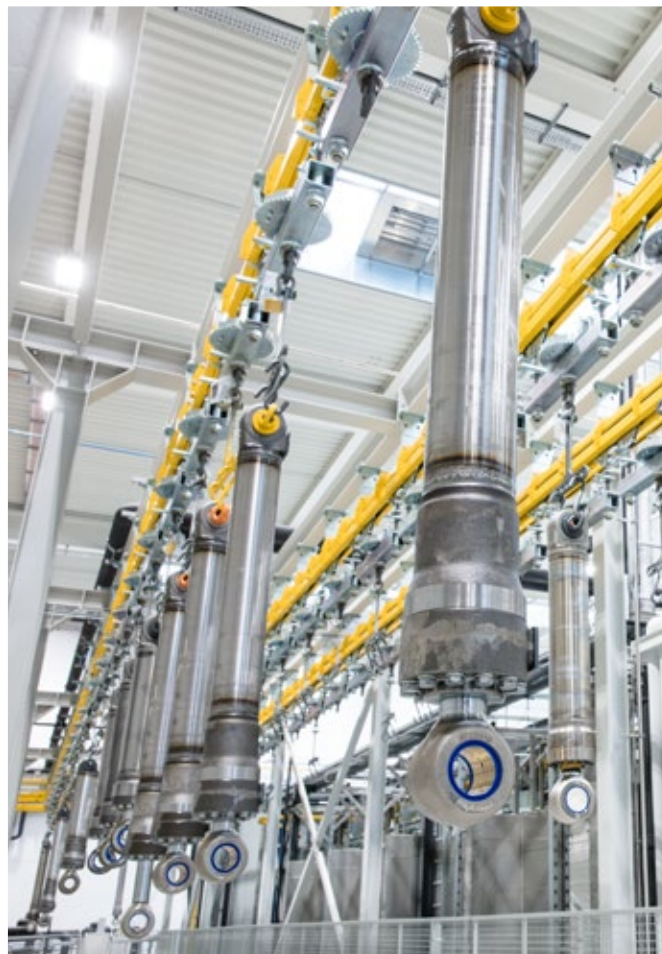
Robotické lakovací zařízení pro sériově vyráběné hydraulické válce
