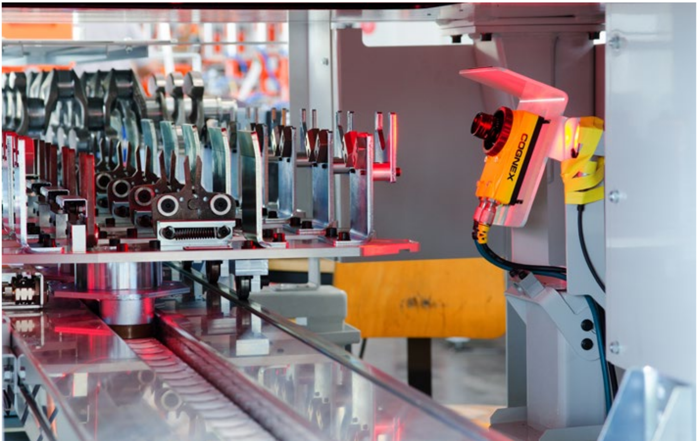
Il nastro a catena in plastica (KKB) come sistema di trasporto ad esempio di alberi a gomito
