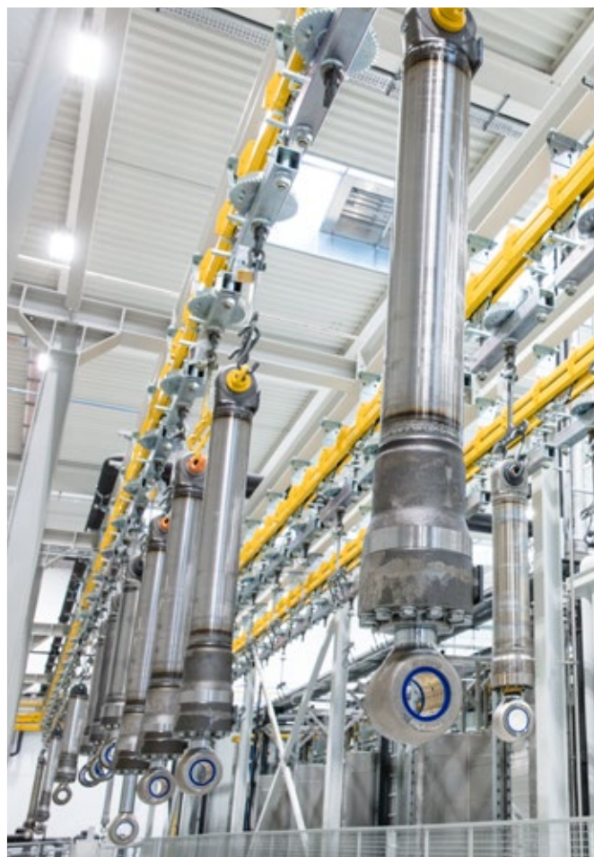
Impianto di verniciatura con robot per cilindri di serie
