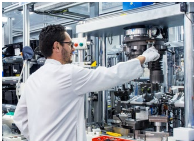
Montaggio di sistemi Common Rail in camera senza polvere
