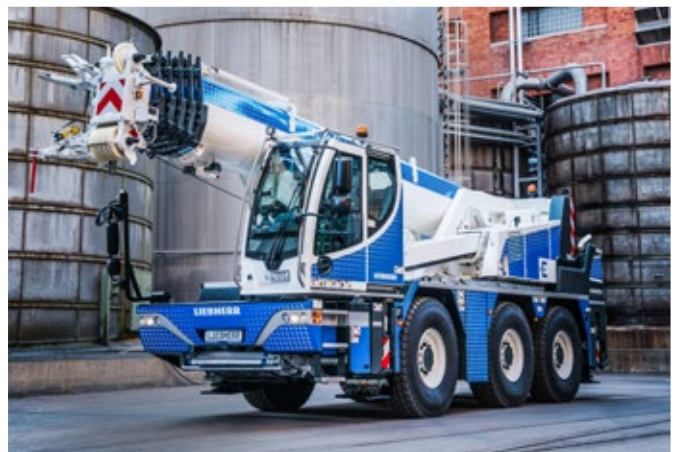
Le gru compatte di Liebherr si contraddistinguono per le loro dimensioni ridotte. Come optional, il modello ibrido può controllare i movimenti della gru attraverso un motore elettrico.
