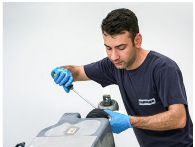
Manutenzione di un attuatore elettroidraulico
