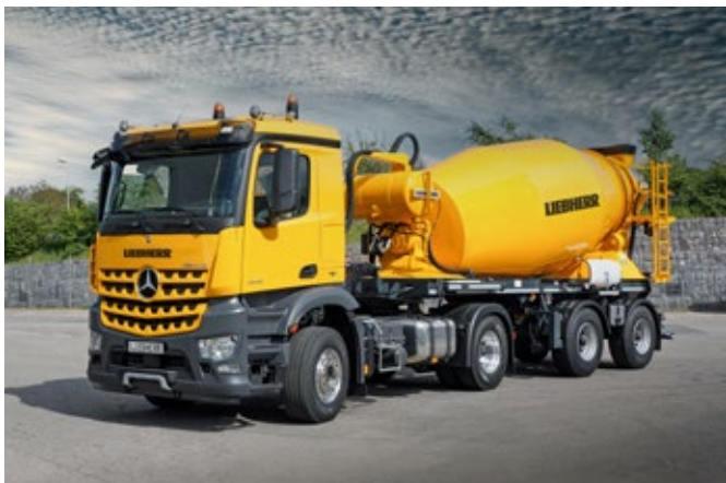
L'autobetoniera HTM 1004 ZA/38 è omologata per un peso complessivo pari a 38 t.
