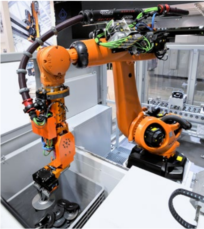
Bin Picking: Scaricamento redditizio di materiale sfuso
