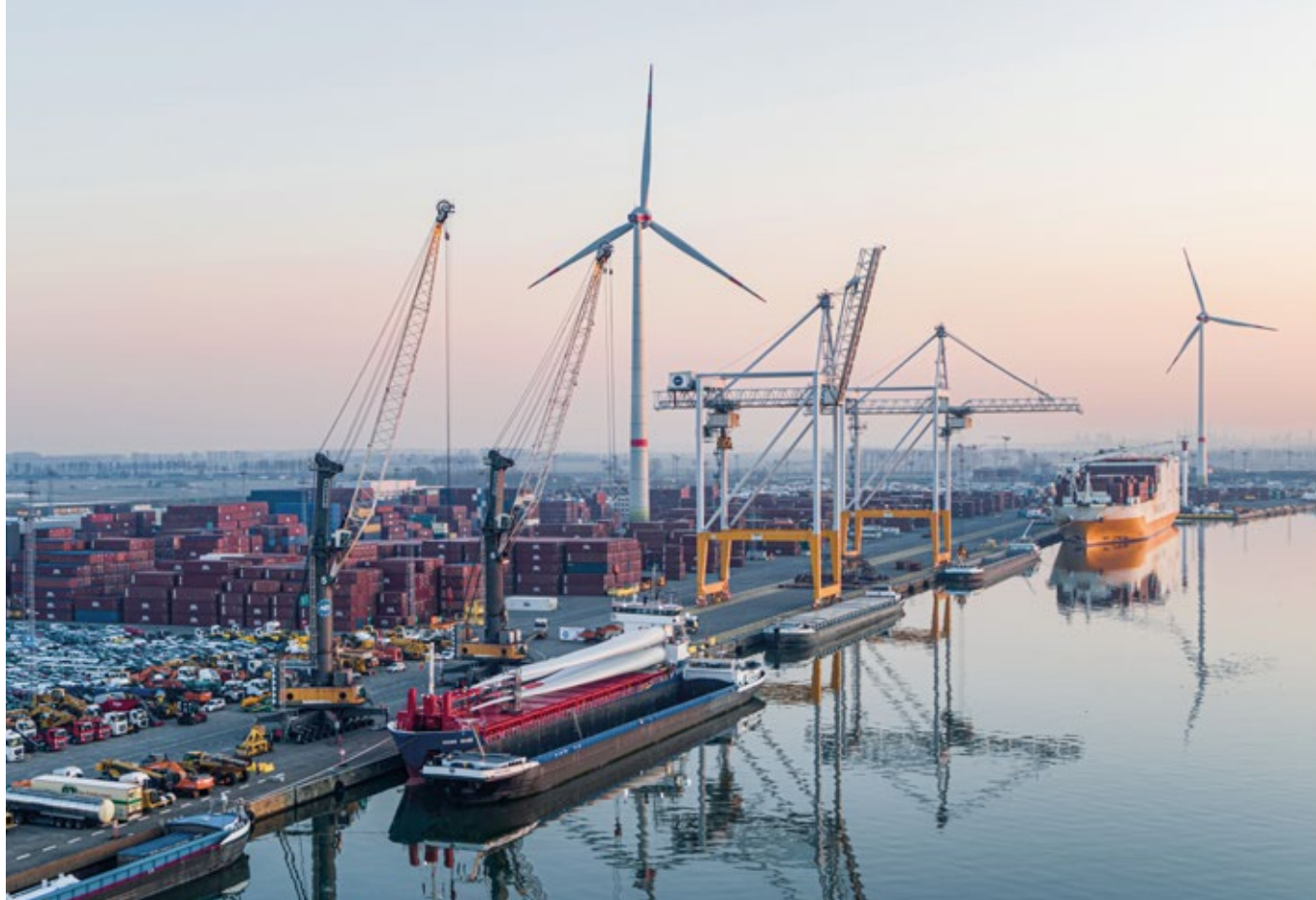
Due gru mobili portuali LHM 550 in un'operazione di sollevamento in tandem presso l'Euroterminal di Anversa (Belgio)
