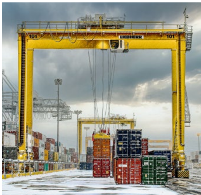
Gru di impilamento Liebherr elettriche presso il Montreal Gateway Terminals (Canada)
