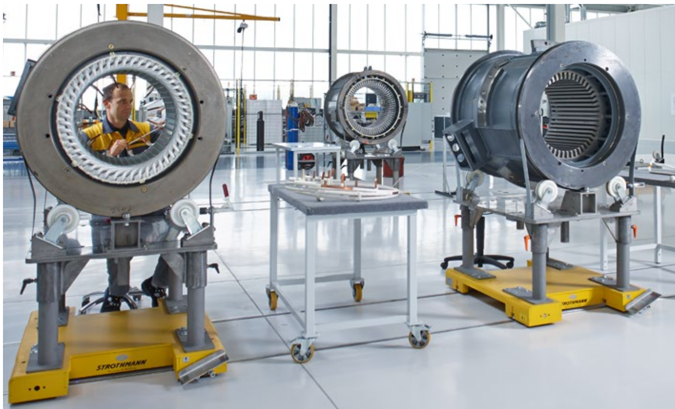
Avvolgimento di macchine elettriche per autocarri per estrazione e gru da porto
