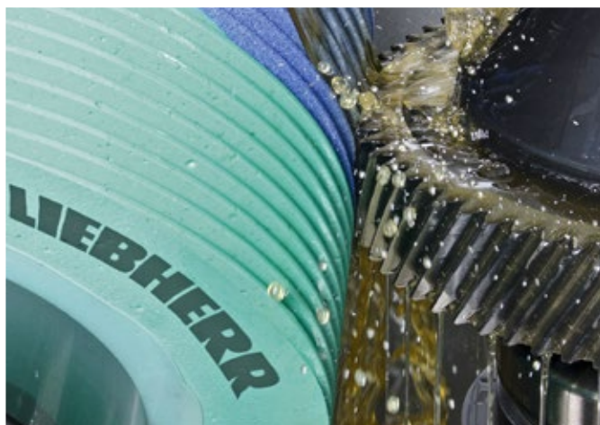
Lavorazione di precisione tramite rettifica e levigatura
