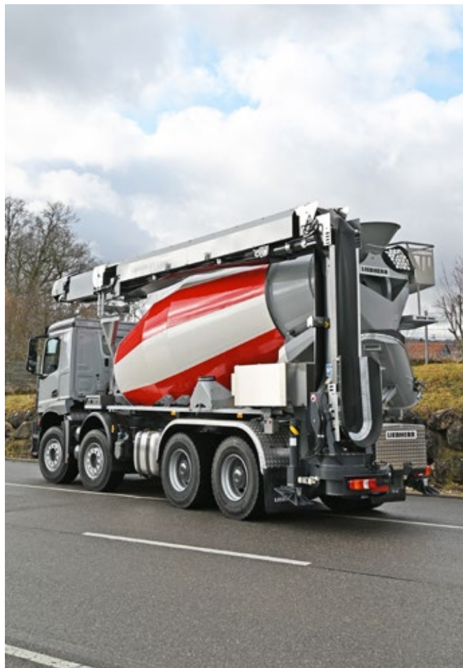
L'autobetoniera HTM 1005 con trasportatore telescopico a doppio nastro LTB 12+4+1
