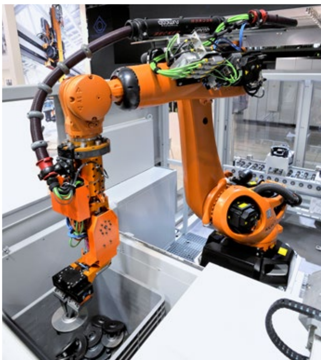
Bin Picking: ömlesztett áru gazdaságos kirakodása
