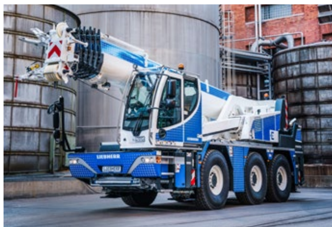
A Liebherr kompakt daruit kis méretük jellemzi. A hibrid modell lehetőséget ad a daru mozgásának elektromos motorral történő vezérlésére.
