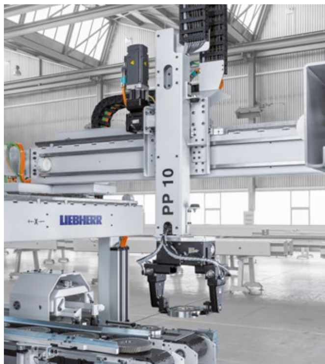
Portál robot 0,5 kg és 1500 kg közötti munkadarabokhoz
