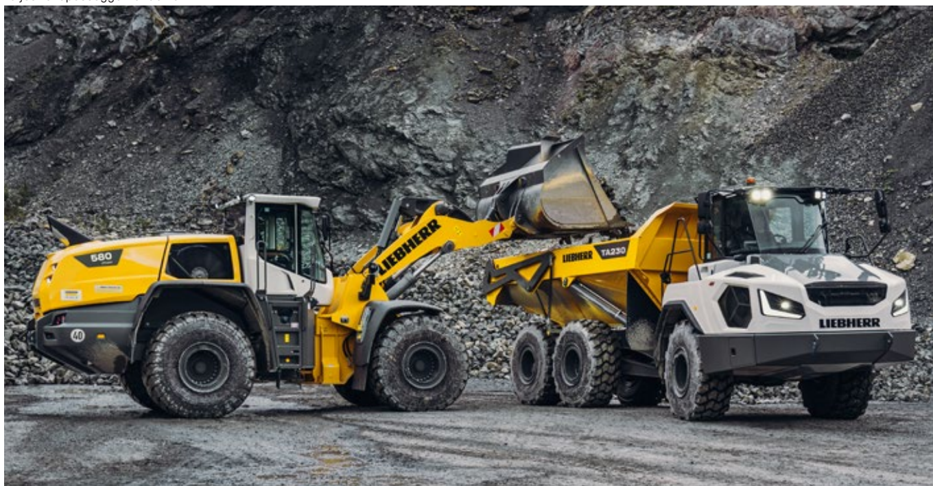
Az L 580 XPower® egy derékcsuklós dömper rakodását végzi.
