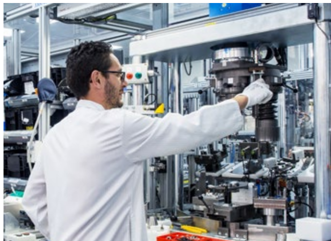
Közös nyomócsöves (common rail) rendszerek tisztatéri összeszerelése
