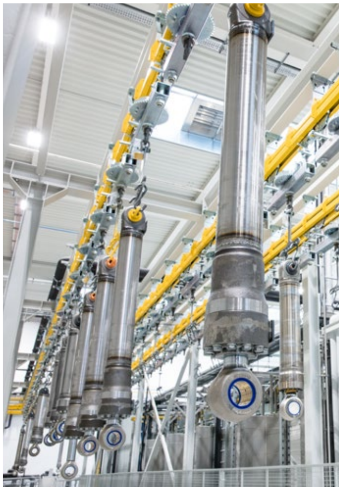
Robotvezérlésű festőberendezés sorozatban gyártott hidraulika munkahengerekhez
