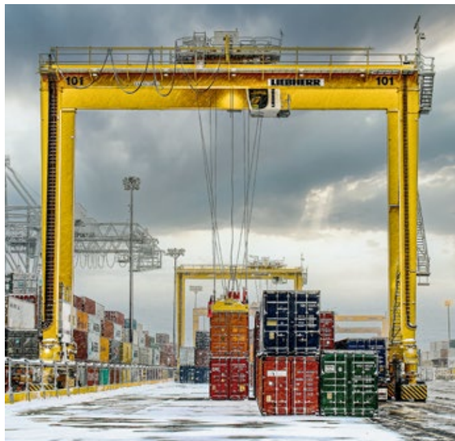
Liebherr elektromos gumikerekes portáldaruk a montreali Gateway terminálon (Kanada)
