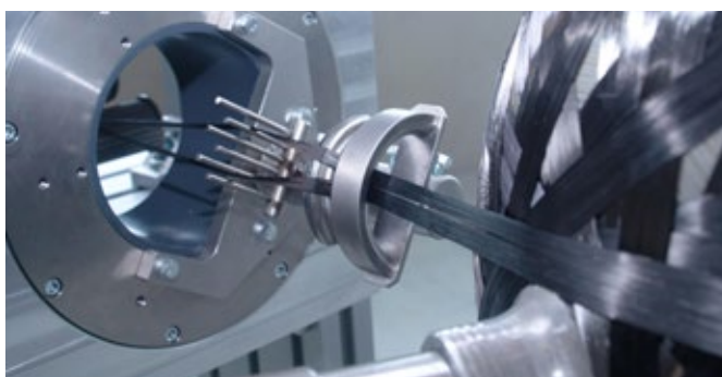
Gyártás a saját CRP robotizált tekercselőgéppel
