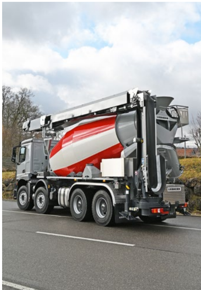
A HTM 1005 betonmixerautó LTB 12+4+1 kettős kitolható szállítószalaggal
