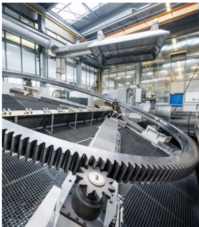
Forgócsap-csapágyak indukciós edzése
