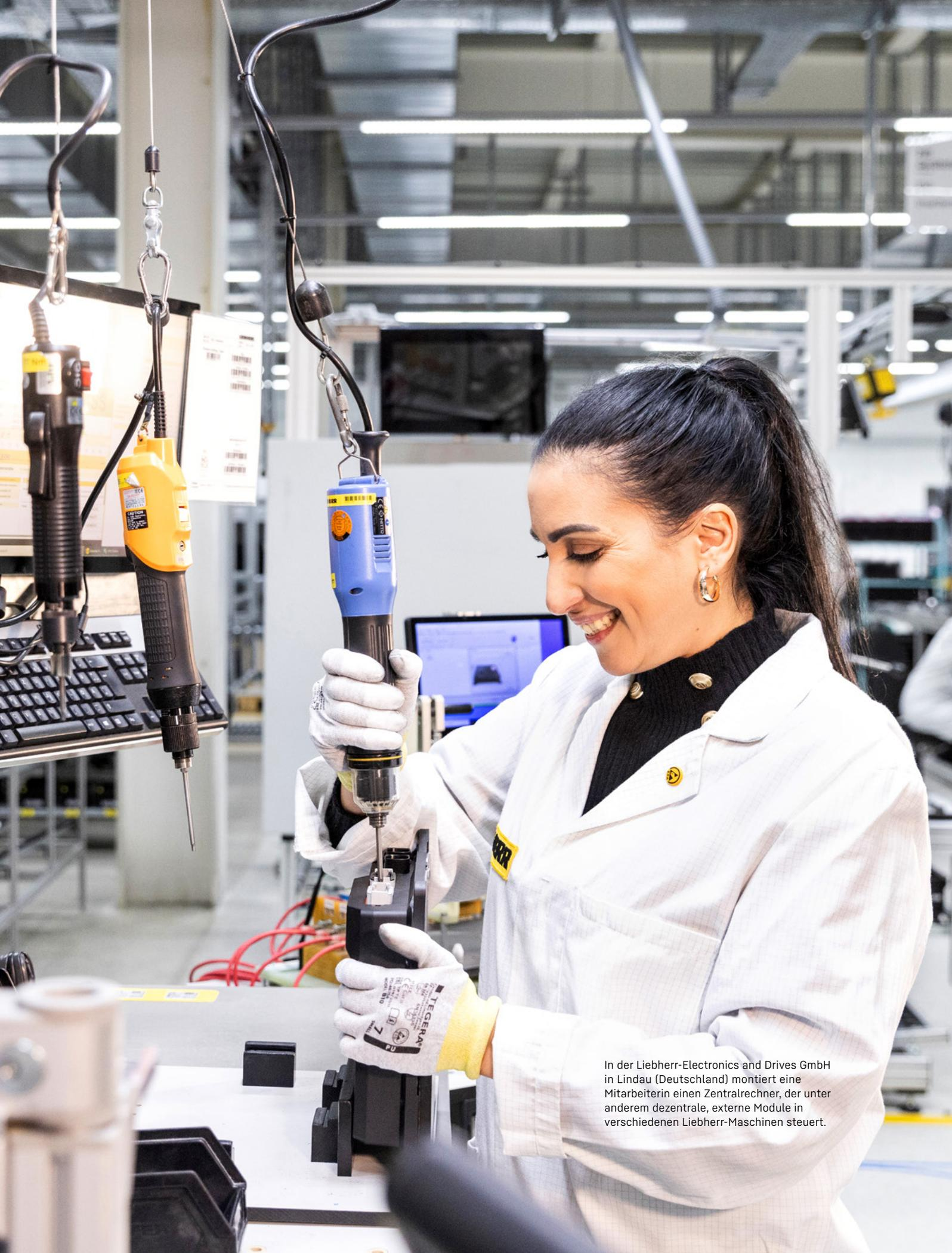
In der Liebherr-Electronics and Drives GmbH in Lindau (Deutschland) montiert eine Mitarbeiterin einen Zentralrechner, der unter anderem dezentrale, externe Module in verschiedenen Liebherr-Maschinen steuert.
