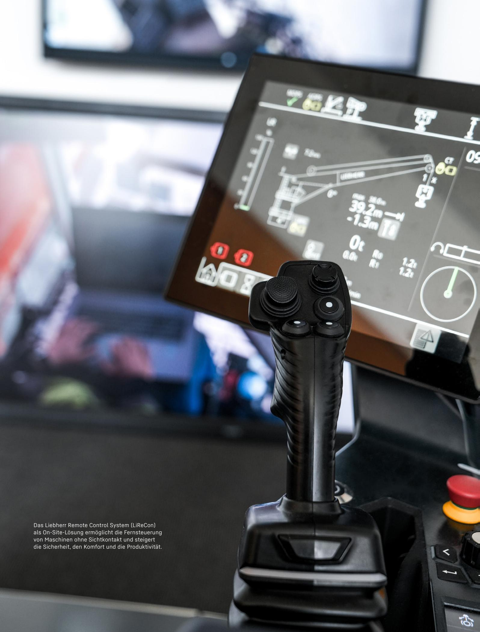
Das Liebherr Remote Control System (LiReCon) als On-Site-Lösung ermöglicht die Fernsteuerung von Maschinen ohne Sichtkontakt und steigert die Sicherheit, den Komfort und die Produktivität.
