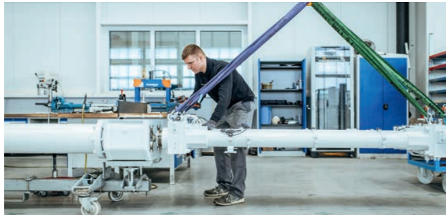
Das Highlight der neuen Autobetonpumpe 42 M5 XXT: die neue Antriebseinheit des Pumpsystems
