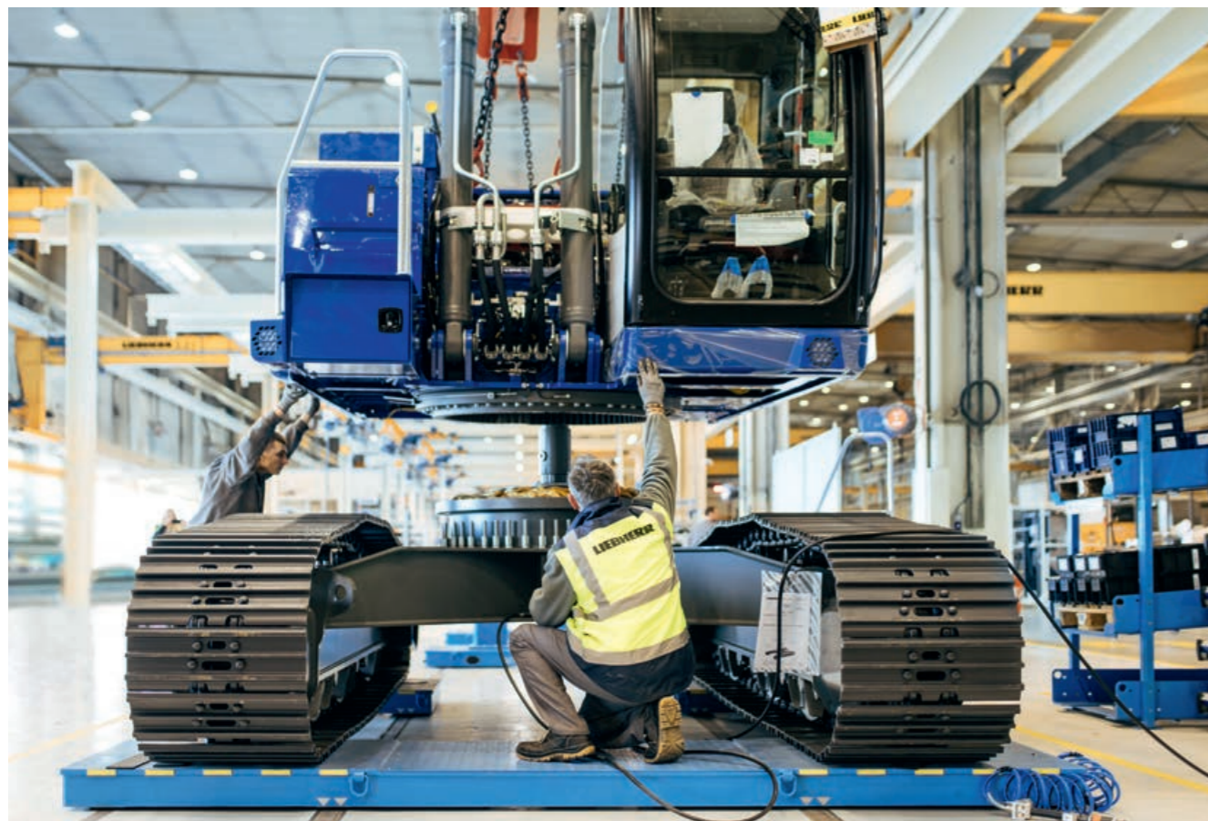
Eine ganz besondere Hochzeit: Ober- und Unterwagen des 60.000. Raupenbaggers werden montiert
