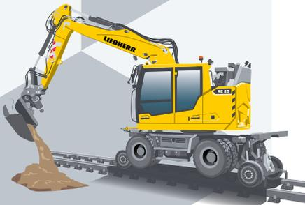
Leistungsstarker Zweiwegebagger mit innovativem Unterwagenkonzept, profolfreiem Oberwagen und neuem Bedienkonzept INTUSI.
