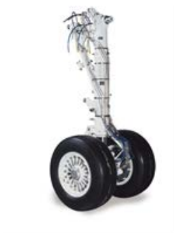
liebherr-embraer190-Hauptfahrwerk-copyright-liebherr.jpg Hauptfahrwerk der Embraer 190 von Liebherr-Aerospace
