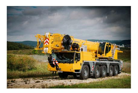
liebherr-mobile-crane-ltm1150-5.3.jpg Новый автокран LTM 1150-5.3 оснащен телескопической стрелой длиной 66 м.
