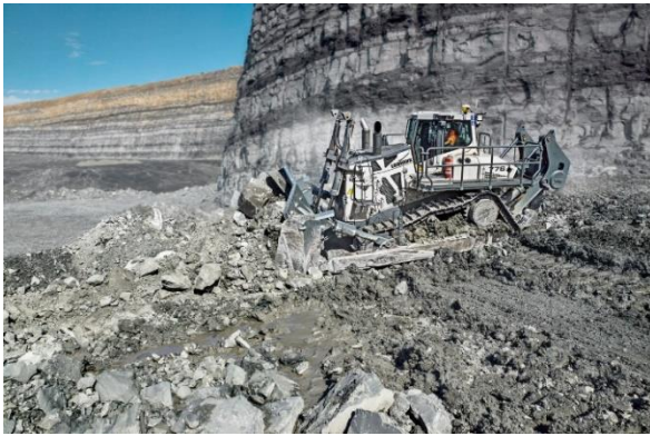
Liebherr-pr776-mining-dozer.jpg 70-тонный бульдозер PR 776.
