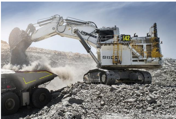
liebherr-mining-excavator.jpg Der R 9600 ist die nächste Generation hydraulischer Miningbagger
