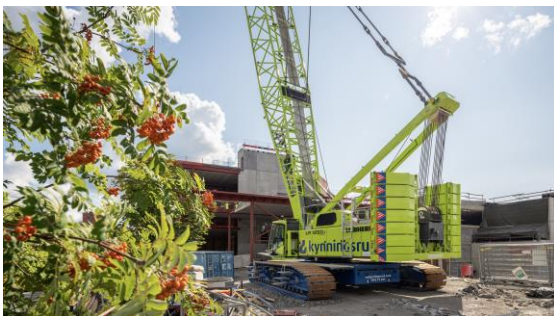
liebherr-lr1250unplugged.jpg Die grüne Alternative: der erste batteriebetriebene Raupenkran.
