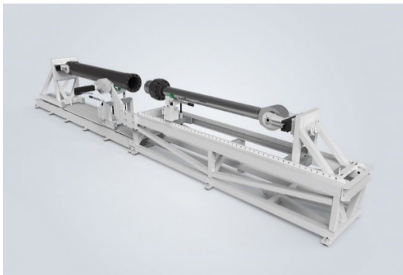
liebherr-montagebank-steel.jpg Liebherr-Components Kirchdorf GmbH setzt eine maßgeschneiderte Montagebank für effiziente und schnelle Reparatur von Hydraulikzylindern ein.
