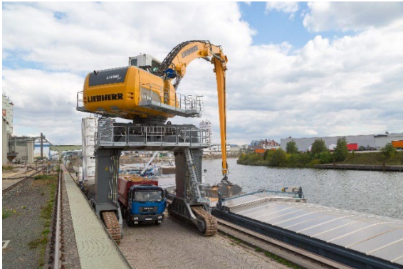
liebherr-lh150c-gantry-port_stagelV-tier4f-IIIA-bamberg.jpg Der Leichtbau-Prototyp im Materialumschlag hat zwei CFK-Hybridzylinder am Ausleger.
