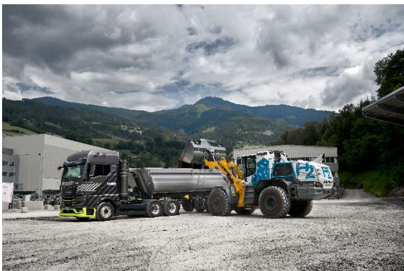
liebherr-L566-H2-wheel-loader-Bischofshofen.jpg L'usine Liebherr de Bischofshofen a présenté la première grande chargeuse sur pneus équipée d'un moteur à hydrogène.
