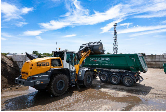
liebherr-xpower-wheel-loader-operation-report-trettin.jpg Fein sortiertes Material wird vom XPower-Radlader in LKWs weiterverladen.
