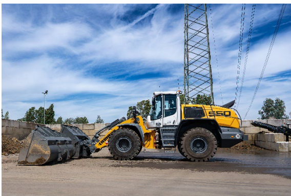
liebherr-wheel-loader-trettin-operation-report.jpg Das Schnellwechselsystem LIKUFIX ermöglicht den Wechsel des Anbaugeräts per Knopfdruck aus der Kabine.
