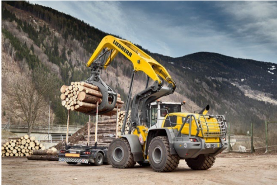
liebherr-l580-loghandler-xpower-version-2023.jpg Der Liebherr L 580 LogHandler XPower® belädt einen Lkw mit Rundholz.
