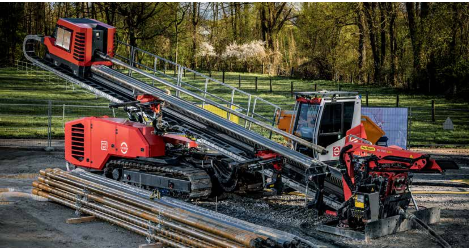
HDD-Bohrgerät (horizontale Richtbohrungen)
