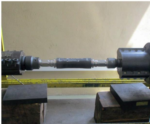
Prüfling im Torsionsprüfstand
