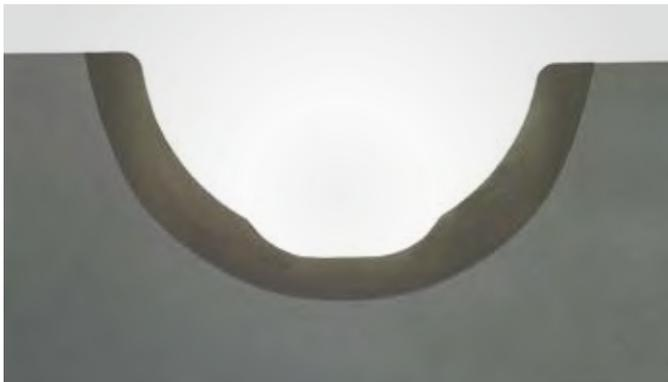
Schliffbild einer Kugeldrehverbindung mit Härteschicht
