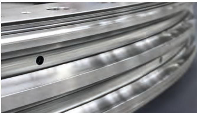
Fertig bearbeitete Kugellaufbahn
