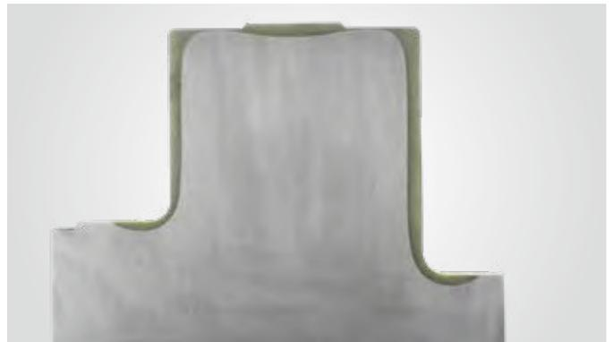
Schliffbild einer Rollendrehverbindung mit Härteschicht
