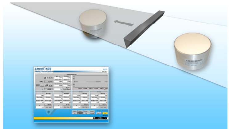
Sensorinstallationen vor und nach Auftrag zur exakten Bestimmung der Schichtdicke bzw. des exakten Flächengewichts.
