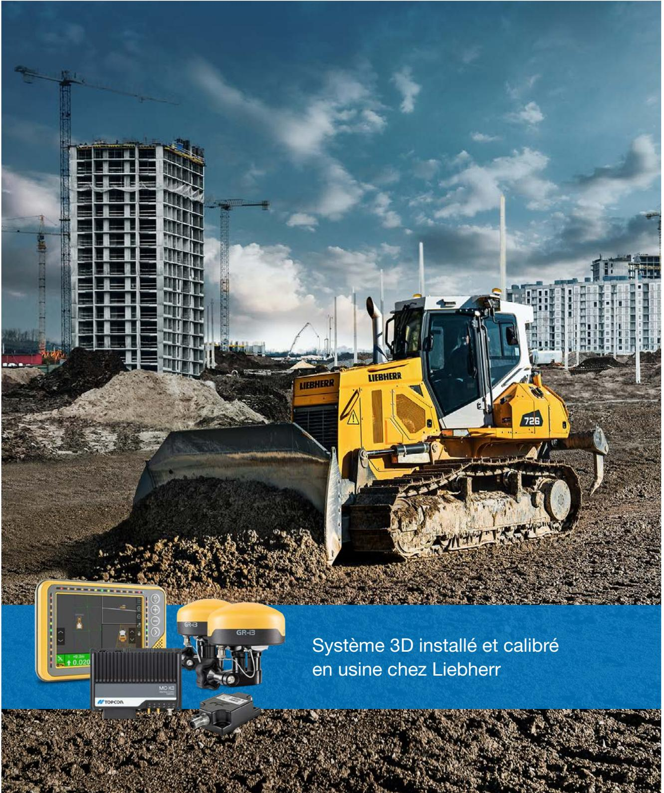
Systeme 3D installé et calibré
