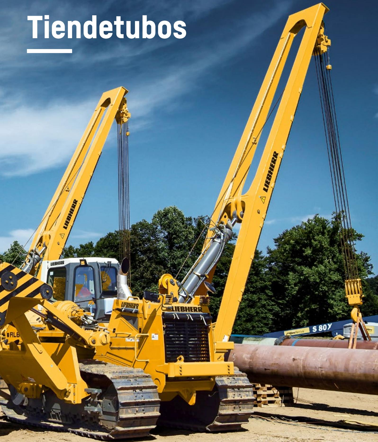
Tanto si se instalan tubos en pendientes como en terrenos blandos: La alta capacidad de elevación, la transmisión hidrostática continua, los elementos hidráulicos de trabajo controlables con precisión y las funciones de seguridad inteligentes permiten obtener la máxima productividad y seguridad en la obra.
