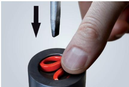
4. Dichtscheibe bis zur Nut niederdrücken, den Schraubendreher in der Mitte des Dichtrings ansetzen und die Finger entfernen.
