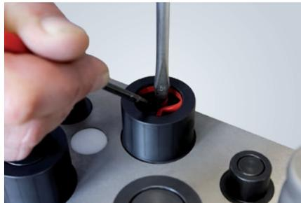
2. Dichtscheibe des Kupplungssteckers mit einem Schraubendreher niederdrücken und oberen Dichtring (rot) mit einem spitzen Werkzeug entfernen.
