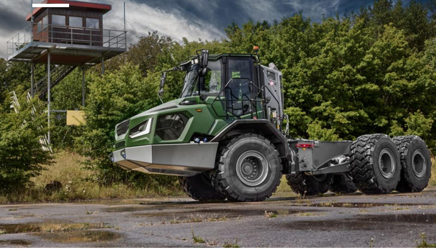
Der TA 230 Litronic als Trägerfahrzeug ist mehr als nur ein knickgelenktes Fahrgestell. Er ist die robuste Basis für Einsätze im anspruchsvollsten Gelände, sei es bei militärischen Pionier- und Logistikkräften, im Zivilschutz oder bei Behörden im In- und Ausland. Dank seiner hohen Flexibilität eignet er sich für unterschiedlichste Aufbauten und Einsatzzwecke, vom Containertransport bis hin zu spezialisierten Verteidigungssystemen.
