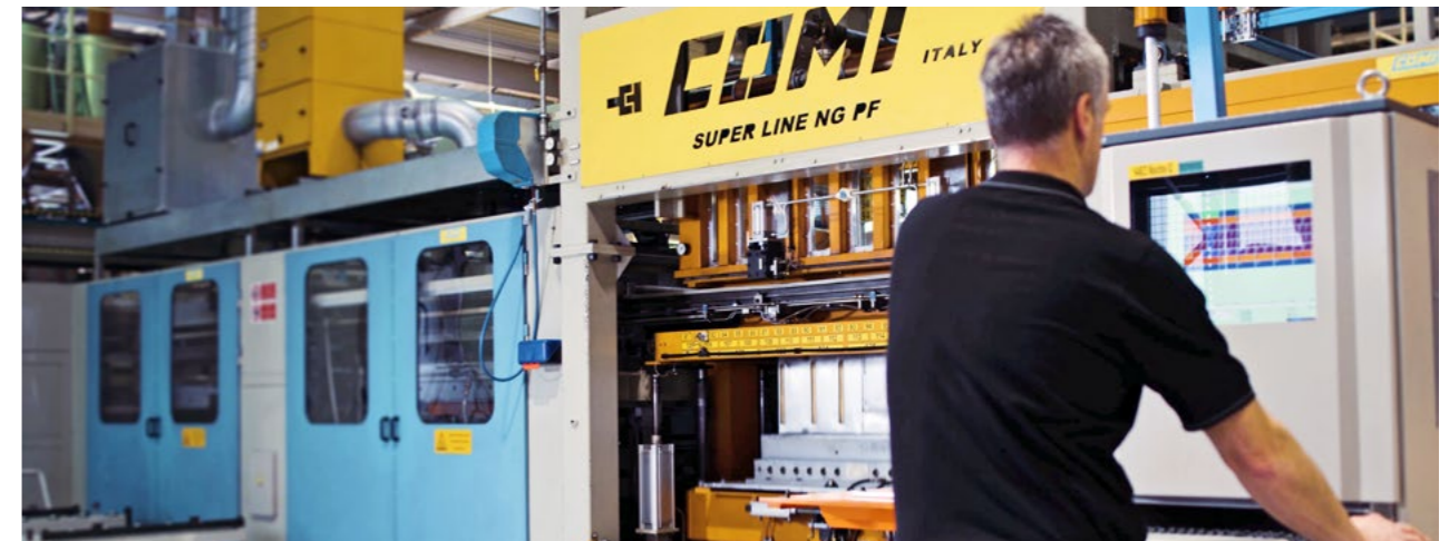
Behälterziehanlage am Standort Ochsenhausen
