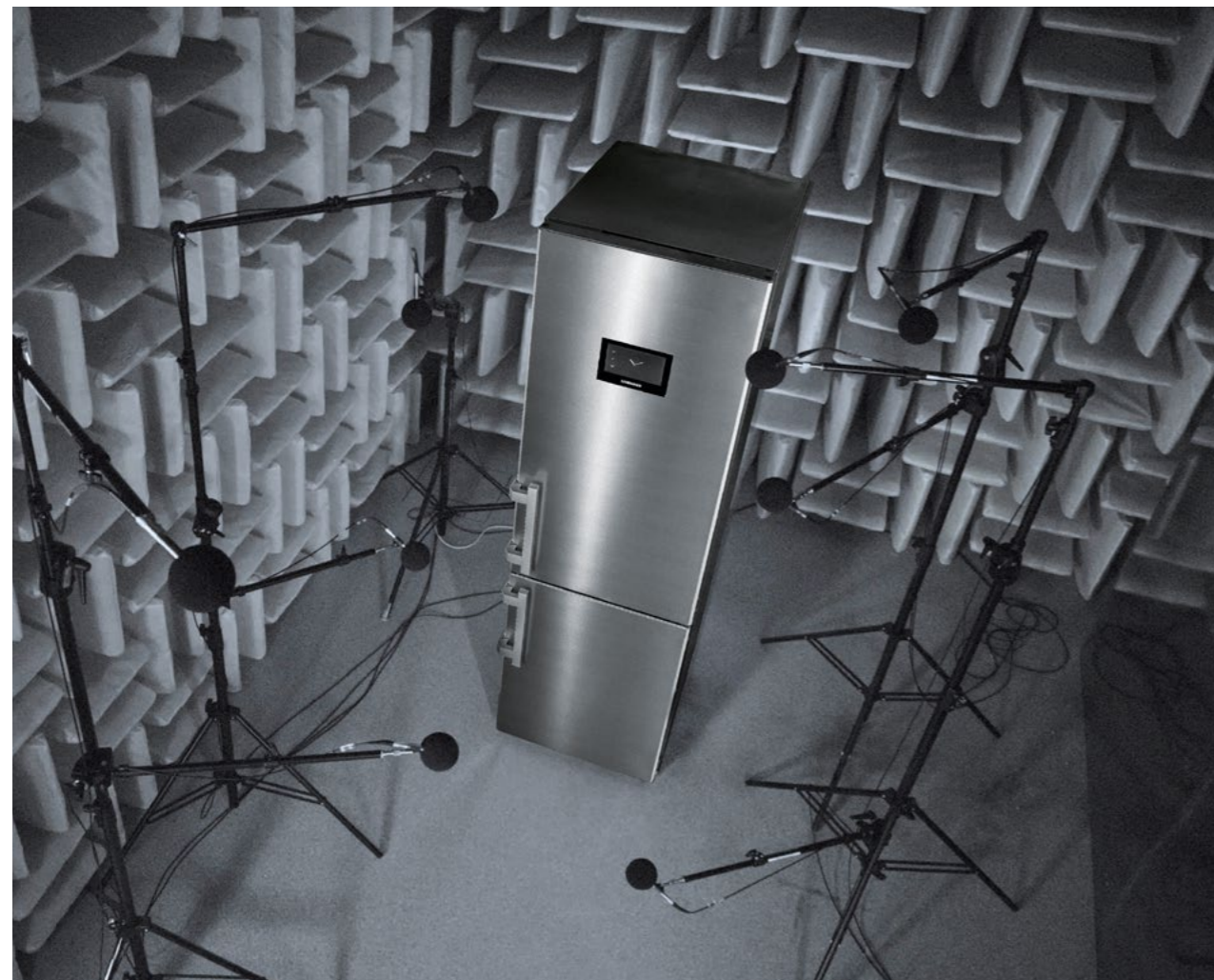
In professionellen Schallmessräumen hören die Ingenieure mit hochempfindlichen Mikrofonen ganz genau hin um Schallemissionen stärker einzudämmen und die Klangqualität von bewegten Komponenten, wie Türen und Auszügen weiter zu optimieren
