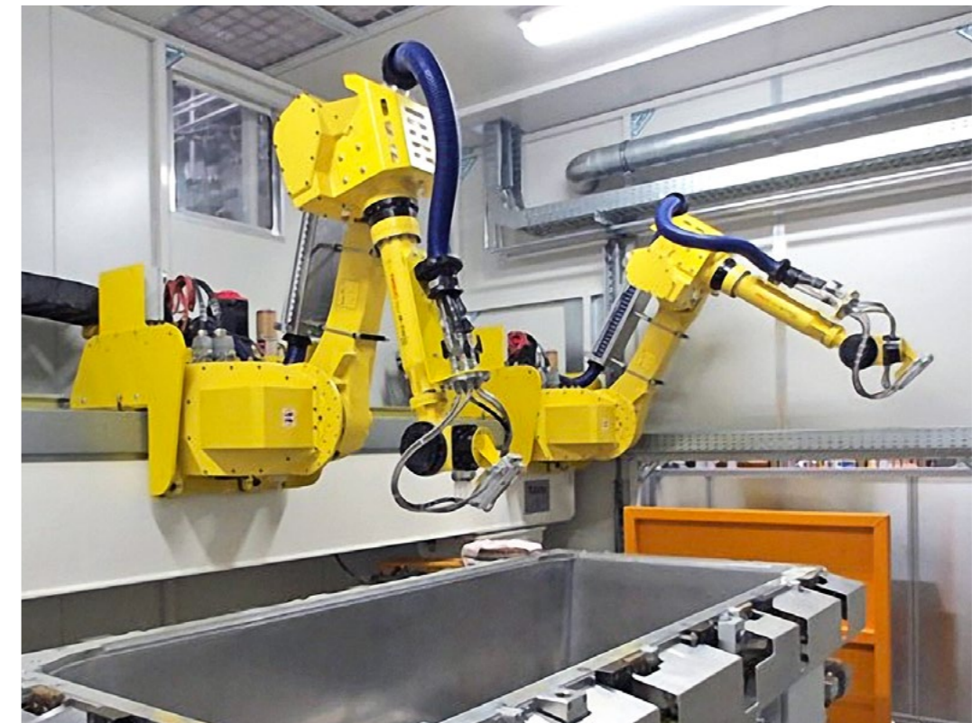
Truhenfertigung in PUR-Sprühtechnik am Standort Lienz
