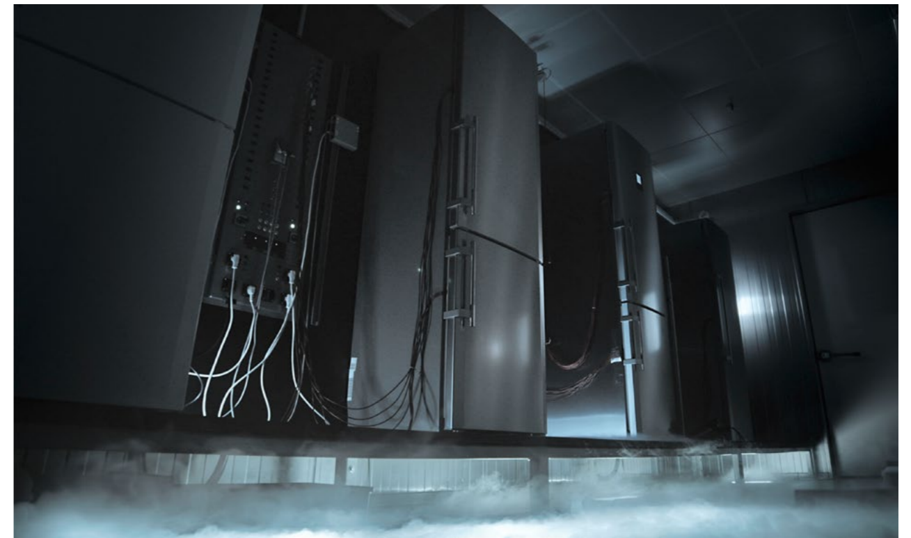
Egal ob bei extremen Temperaturen oder hoher Luftfeuchtigkeit – in den Klimakammern stellen die Geräte in Langzeittests ihr vielseitiges Können über die üblichen Messzeiträume hinaus unter Beweis
