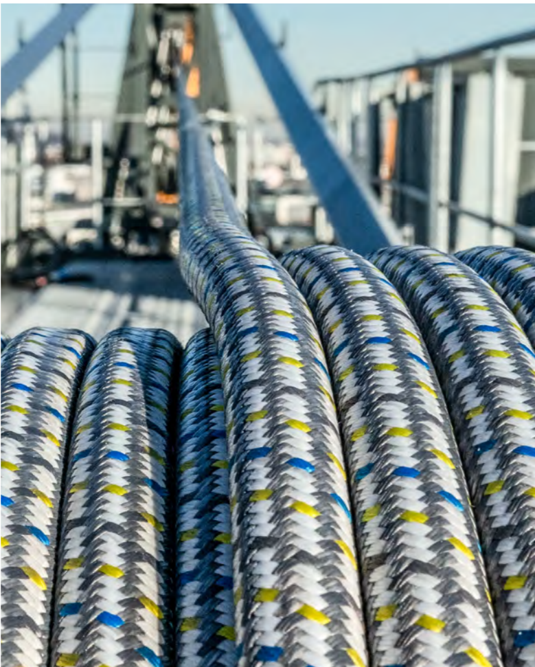
Le câble du futur : une technologie de pointe en fibres synthétiques pour des grues encore plus puissantes
