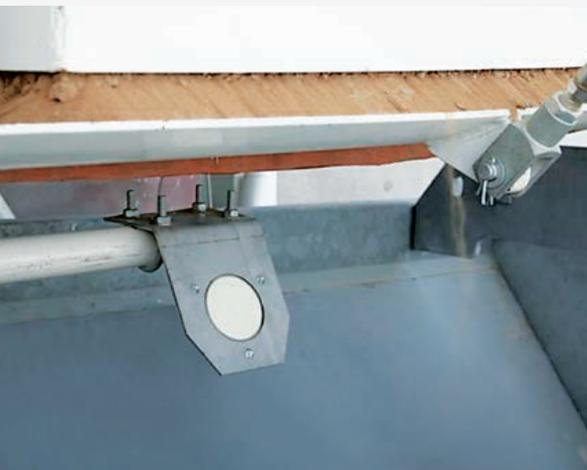
Mesure de l'humidité Litronic-FMS
