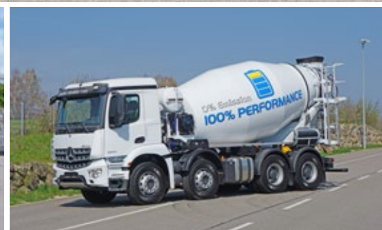
ETM 905 (электрический привод барабана)
