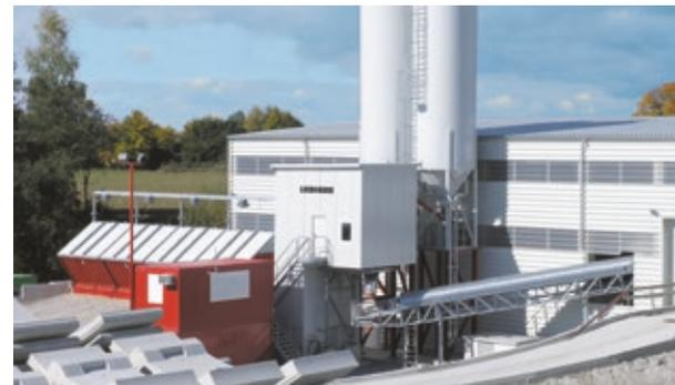
Compactmix 1.0 mit Einhausung an ein Fertigteilwerk angegliedert
