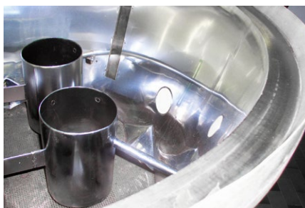
Einsatz im Wirbelschichttrockner bei der Saatgutherstellung
