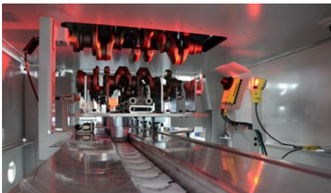
Kamerasystem in einer Kurbelwellen-Linie
