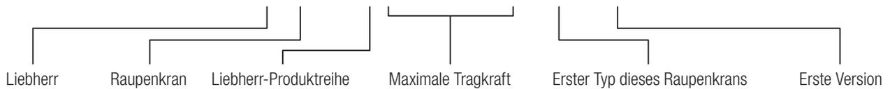
Mit dem neuen Krantyp führte Liebherr eine neue Endung der Typenbezeichnung für Raupenkrane ein: Die „1“ hinter dem Bindestrich steht für den ersten Typ des 800-Tonnen-Raupenkranes. Die „0“ hinter dem Punkt bedeutet die erste Version: Diese Ziffer wird sich bei zukünftigen maßgeblichen technischen Änderungen jeweils um 1 erhöhen.
