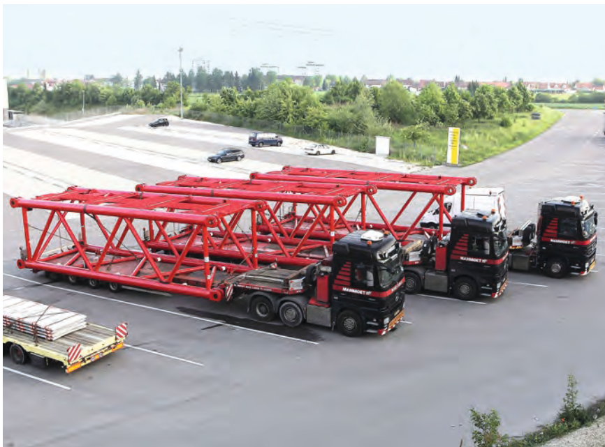
Gitterstücke des LR 13000 bereit zum Abtransport in Ehingen
