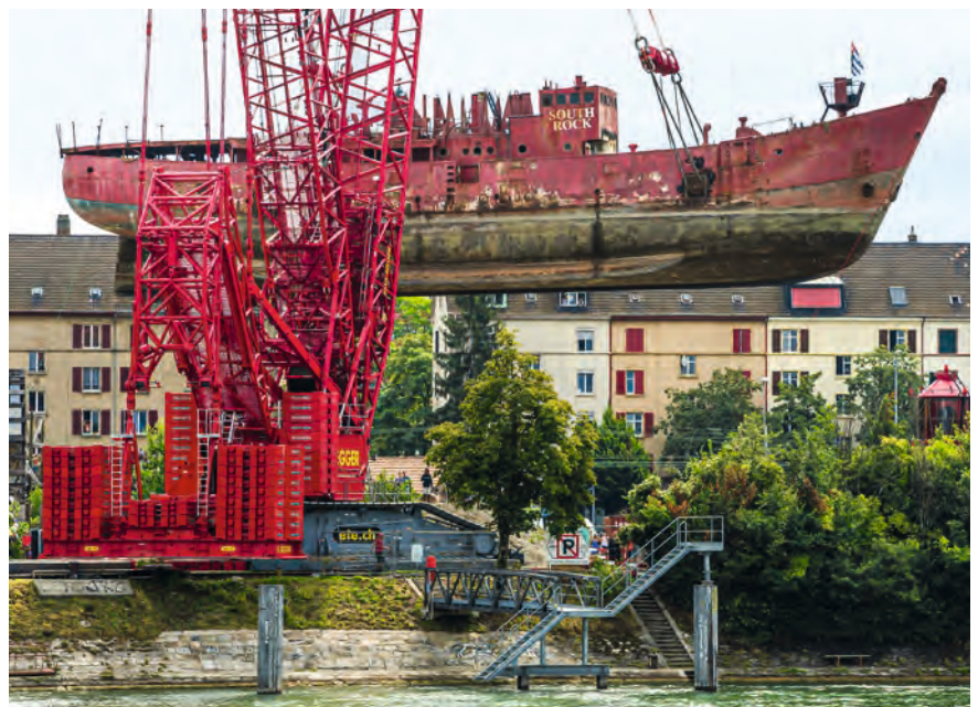
Der verstellbare Ballast ermöglichte das Schwenken vorbei an Gebäuden und Hindernissen.
