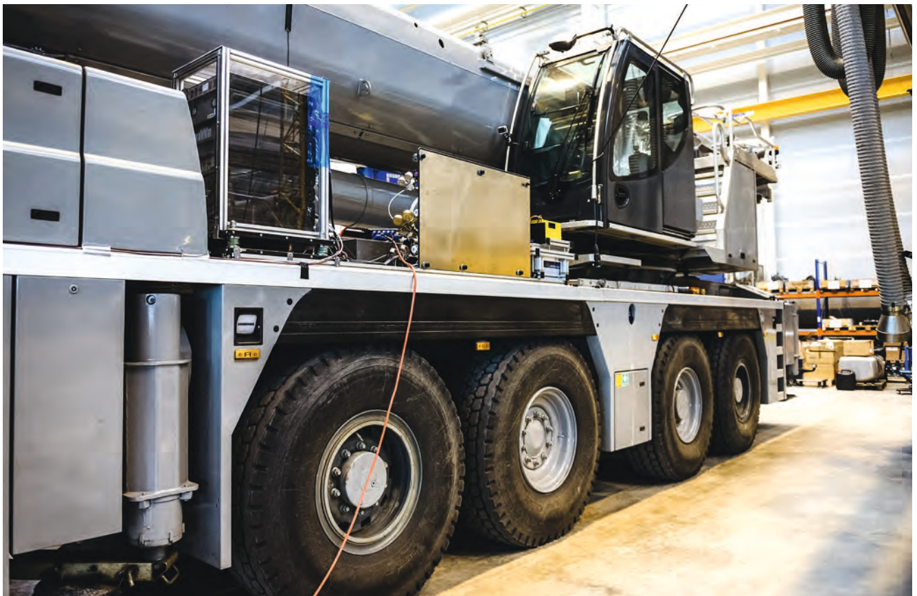
Die Messvorrichtungen am LTM 1160-5.2
