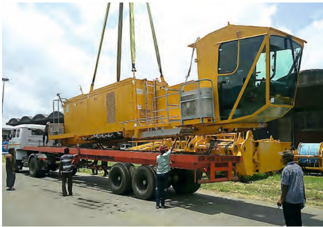
Verladen der Drehbühne des LR 11350 in Bangladesch
