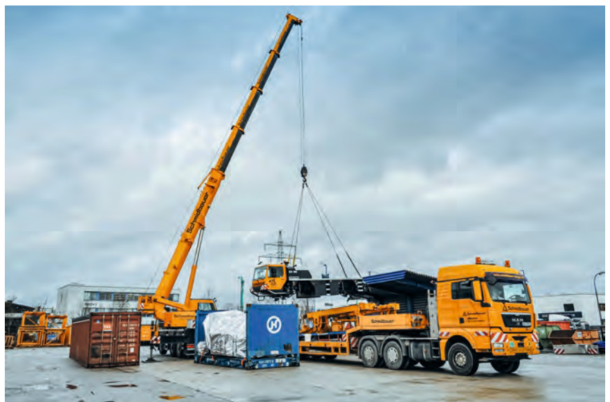
Sicher verpackt tritt der Kran in Einzelteilen auf Lastkraftwagen die Reise zum Hamburger Hafen an, wo er auf das Containerschiff „Cartagena Express“ verladen wird.
