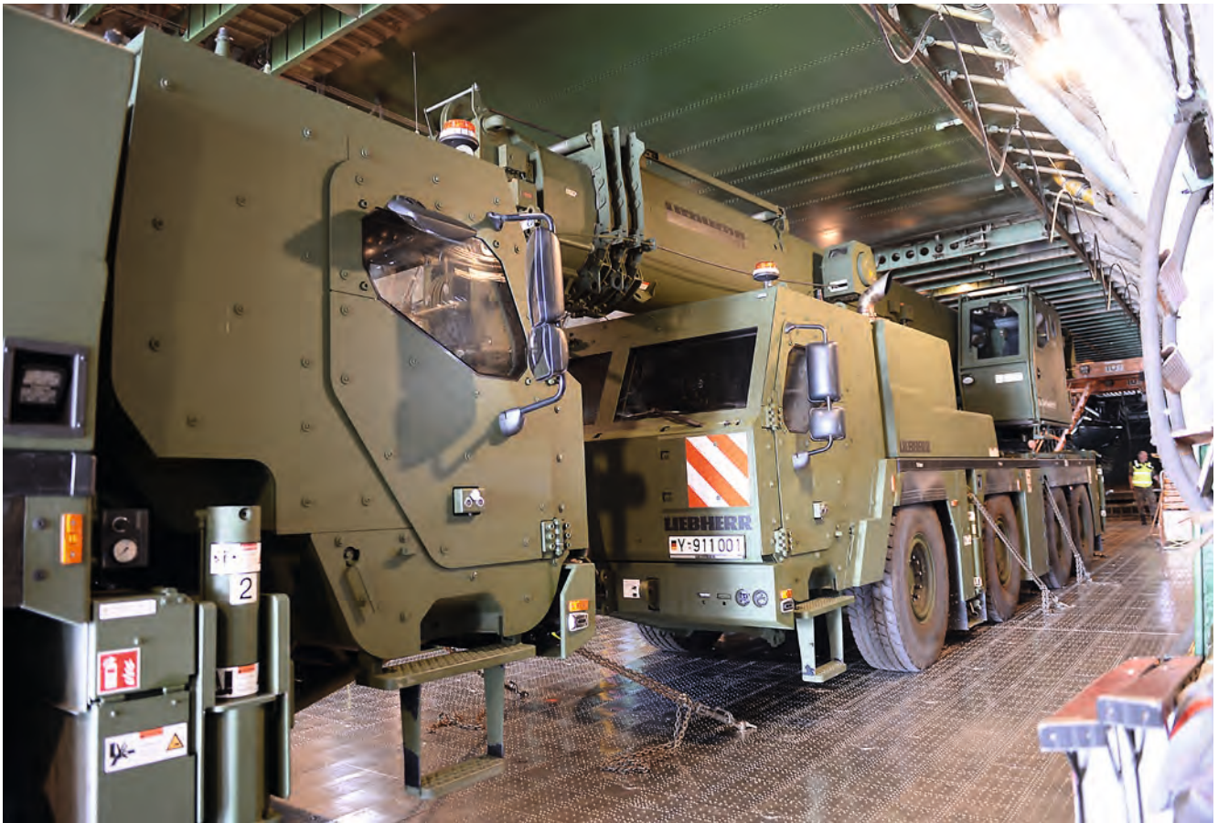
Die ersten sind bereits angeschlagen: Jeder Kran wird mit 36 Ketten in der Antonov befestigt.
