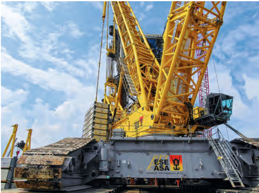
Den äußerst tragfähigen Drehkranz des LR 13000 hat Liebherr selbst entwickelt.
