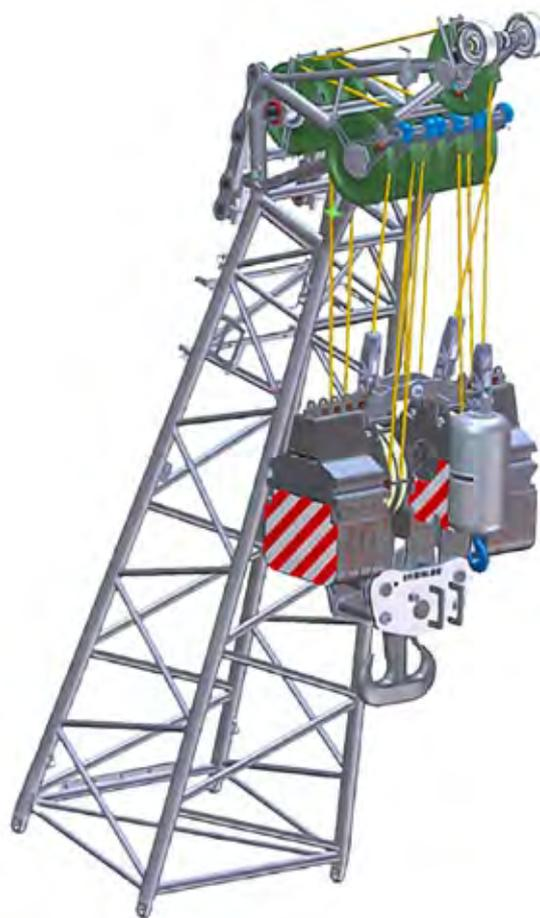
Mástil saliente integrado y gancho ancho para el funcionamiento en paralelo
