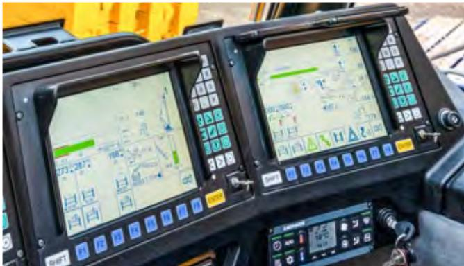
Todos los parámetros del estado de la grúa y del proceso de elevación se comunican a la cabina del conductor de la LR 1700-1.0 a través de los sistemas. La pantalla de la derecha muestra un caso de carga actual de 86 toneladas.
