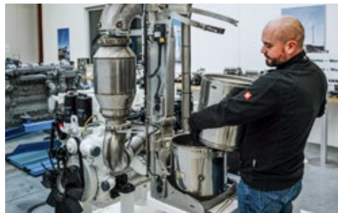
El entrenador Thomas Fritsch demuestra el cambio del filtro de partículas diésel en un modelo en el centro de entrenamiento en Ehingen.
