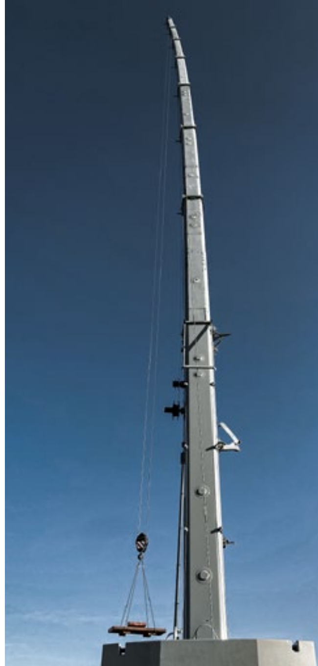
LTM 1300-6.3 con pluma de 90 metros: curvatura lateral de la pluma debida a la radiación solar y a la carga máxima suspendida.
