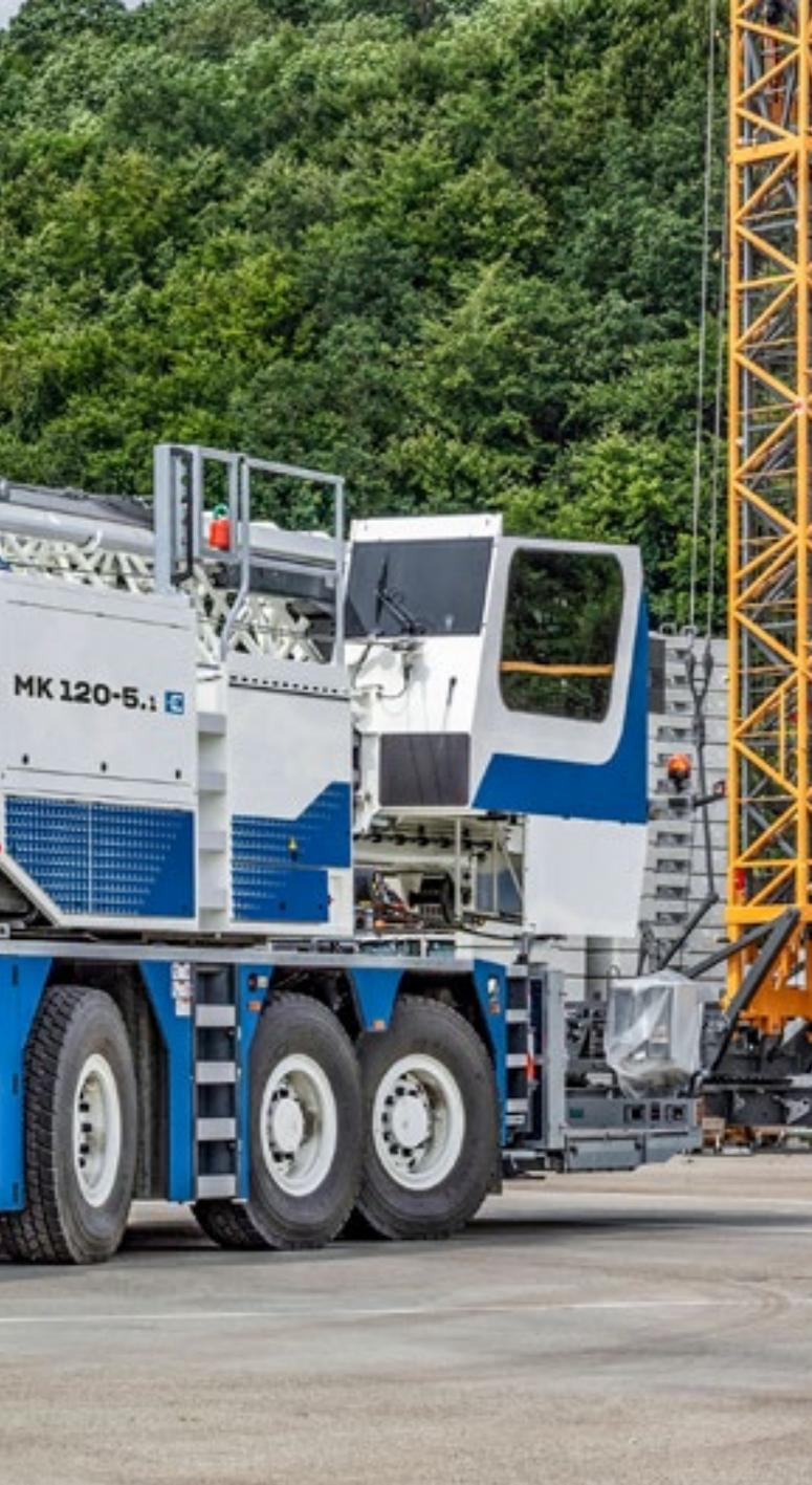
Der MK 120-5.1 bietet mit seiner Auslegerlänge von 52 Metern und einer maximalen Traglast von 2.100 Kilogramm an der Spitze eine beeindruckende Leistung. Mit diesen Werten erweitert er das bestehende MK-Portfolio und schließt die Lücke zwischen dem MK 88-4.1 und dem MK 140-5.1. Der Mobilbaukran besticht außerdem mit seiner hohen Wendigkeit, die durch einen engen Wendekreis auch das Manövrieren in schmalen Straßen und Kreuzungen ermöglicht.
