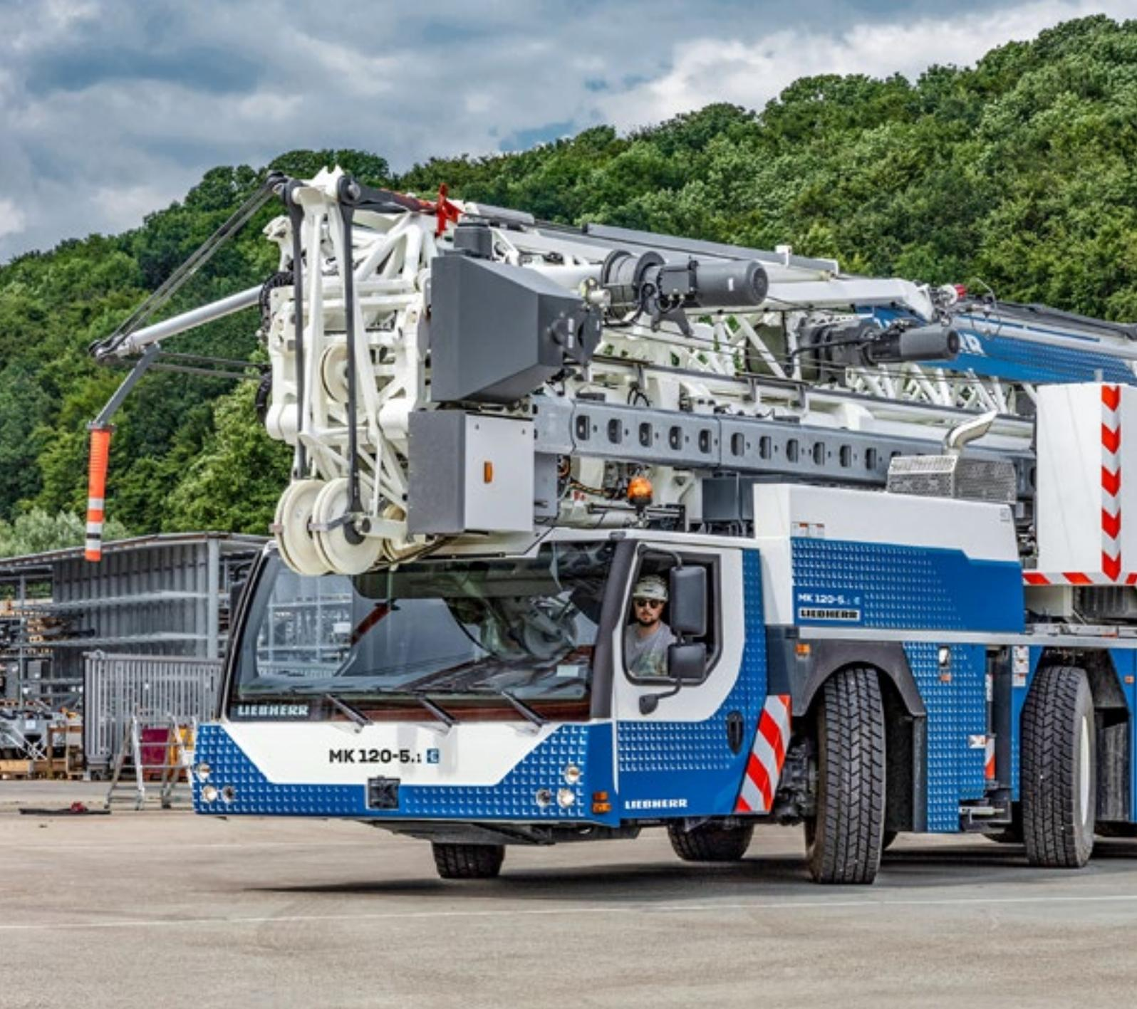
Die Familie der Liebherr-Mobilbaukrane wächst: Der MK 120-5.1 kann an der Auslegerspitze bis zu 2.100 Kilogramm heben.
