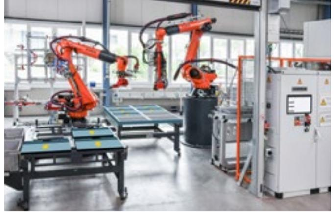
Liebherr-Pilotanlage für die automatisierte Demontage von Batteriepacks
