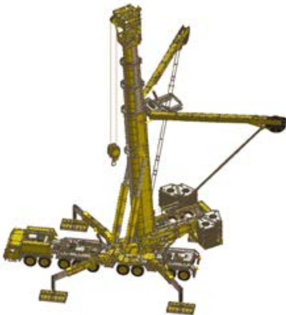
La maqueta de la grúa terminada pesa 120 kilogramos y se apoya como una grúa grande.
