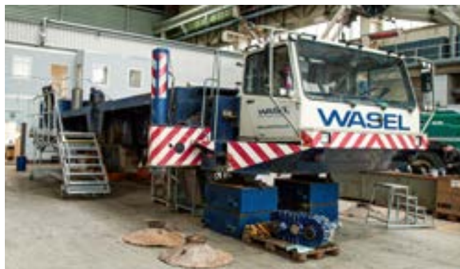
Desmontada hasta el esqueleto: Los especialistas de Liebherr desmontaron completamente la grúa RT para la revisión general.
