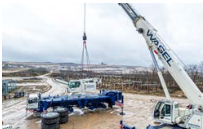
Montaje final: el montaje final de la LTL 1160 tras su revisión general de 2024 tuvo lugar en la misma mina de Hambach.
