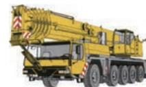
Le vent latéral est particulièrement dangereux sur la flèche de la grue et la charge. Il n'est pas enregistré par la limitation du couple de charge. La grue peut donc être surchargée.
