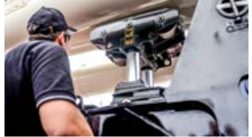
Am Heck des Krans ist eine Vorrichtung angebaut, die den Ausleger hebt.
