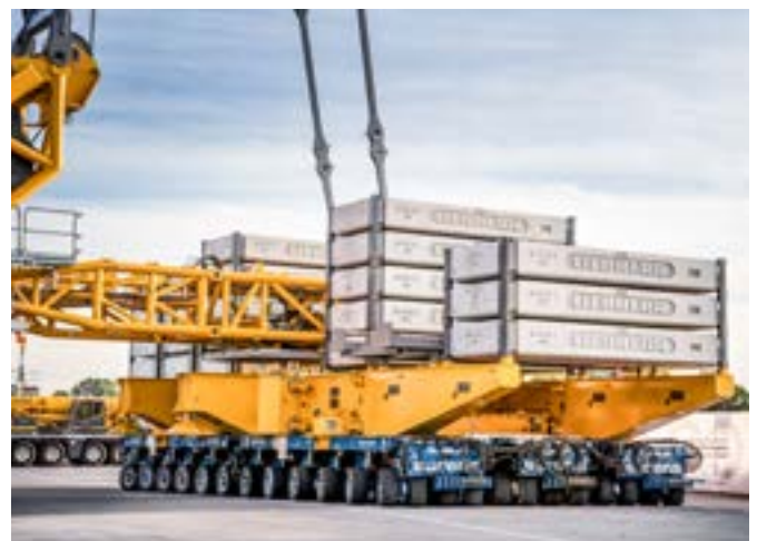
36 SPMT-Achsen werden als Ballastwagen für den LR 12500-1.0 eingesetzt.
