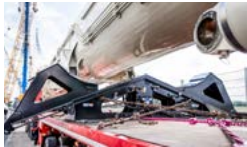
Damit sich der Ausleger frei bewegen kann, wird die Transportablage hydraulisch auseinandergefahren.
