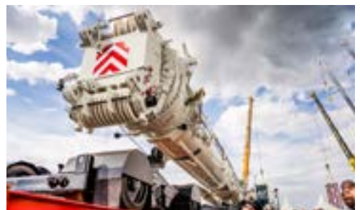
Nach dem Lösen des Rollwagens kann der Ausleger aufgewippt werden.
