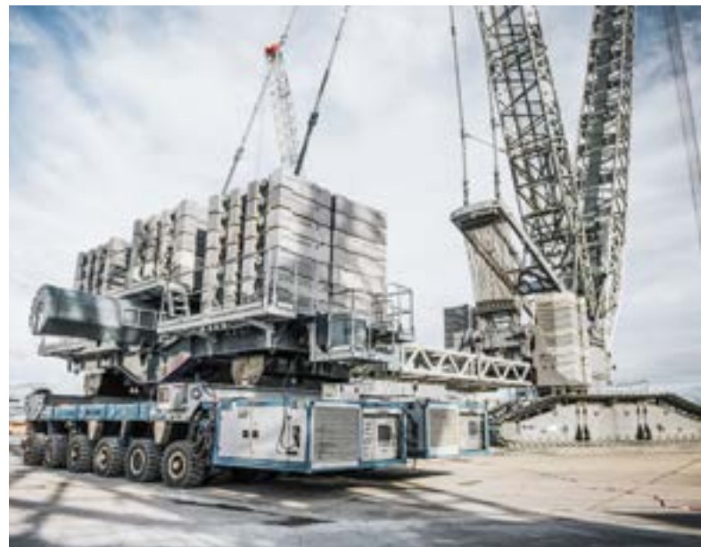
Es wurden bereits erfolgreiche Versuche mit dem LR 11000 und SPMTs als Ballastwagen durchgeführt.
