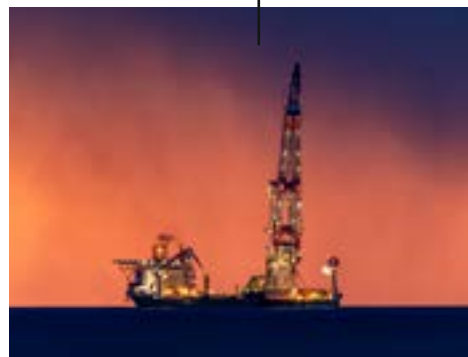
La grúa pesada de alta mar HLC 295000, con una capacidad de elevación de hasta 5.000 toneladas.
