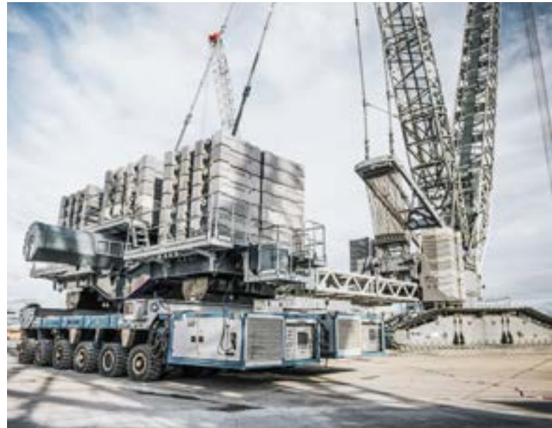
Ya se han realizado con éxito pruebas con la LR 11000 y SPMT como carro de contrapeso.
