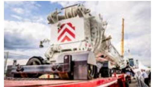
El carro con propulsión por cadena empuja la pluma hacia la grúa para el montaje.
