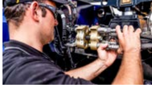
El sistema hidráulico es conectado con acoplamientos rápidos.
