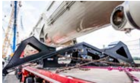
Para que la pluma pueda moverse libremente, el soporte de transporte se separa hidráulicamente.
