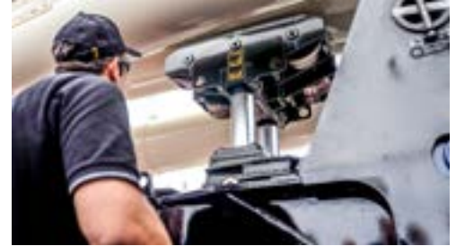
En la parte trasera de la grúa hay un dispositivo instalado que levanta la pluma.
