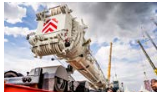
Después de desligar el carro con propulsión por cadena, la pluma puede ser elevada.
