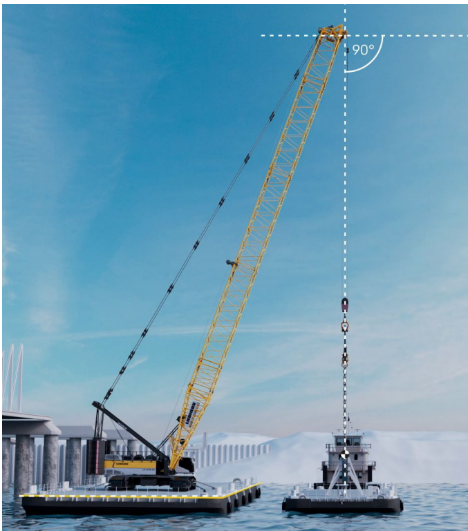
Per Knopfdruck positioniert sich der Ausleger automatisch über dem Schwerpunkt der Last. Dadurch wird Schrägzug vermieden und die Last kann pendelfrei gehoben werden.
