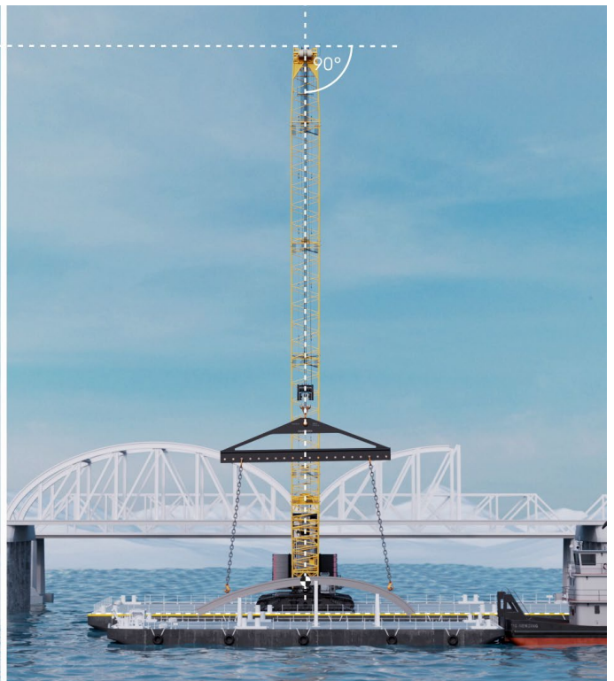
Per Knopfdruck positioniert sich der Ausleger automatisch über dem Schwerpunkt der Last. Dadurch wird Schrägzug vermieden und die Last kann pendelfrei gehoben werden.
