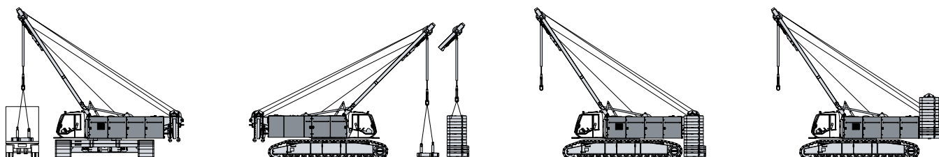
Entladung, Zusammen- und Anbau des Heckballastes
