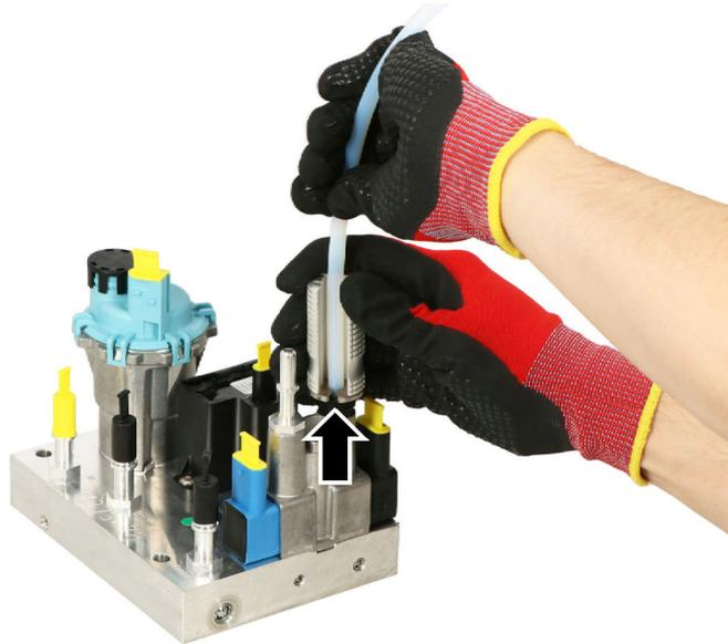
Fig. 64: Sacar el conducto de aire defectuoso
