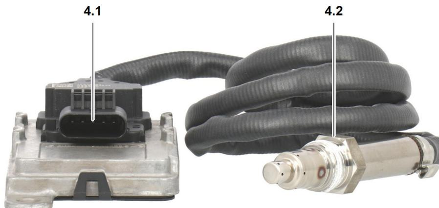
Fig. 52: Desmontar el sensor NOx
