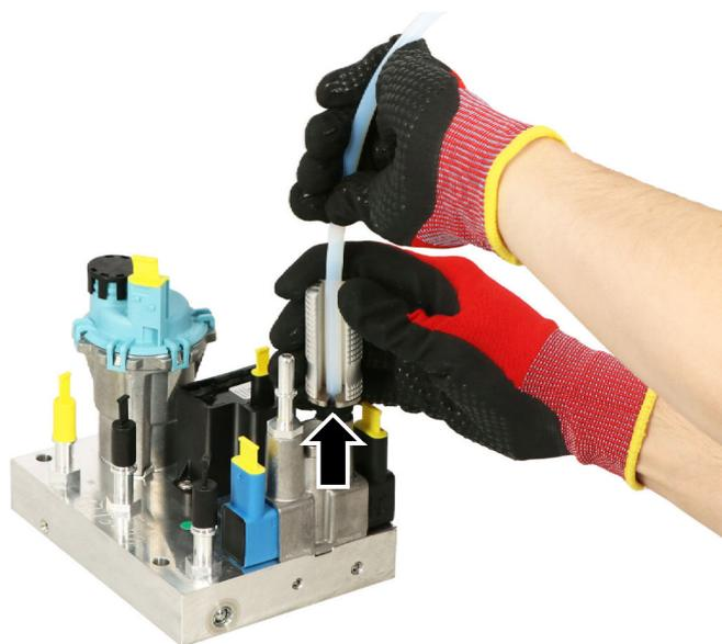
Fig. 50: Sacar el conducto de aire
